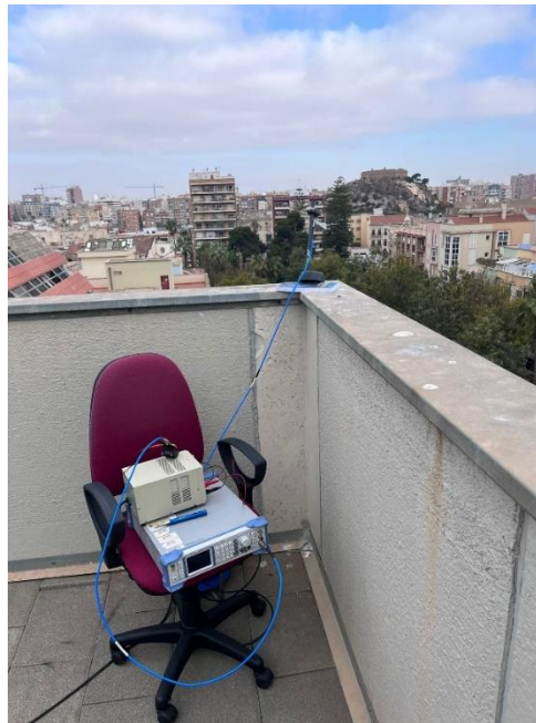
Figura 25. Foto del Transmisor utilizado
