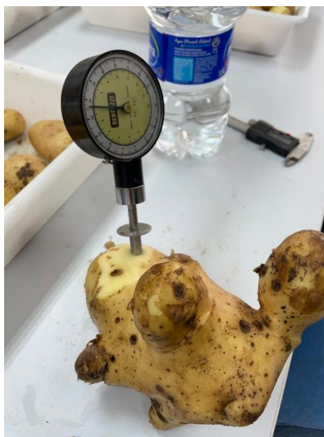
Figura 7. Fotografía que muestra la técnica de medición de la firmeza de la patata utilizando un penetrómetro.
