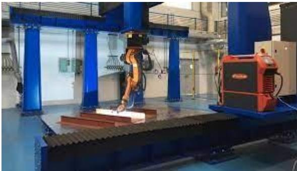
*Imagen 3. 2. Soldadura automatizada con robot.*
