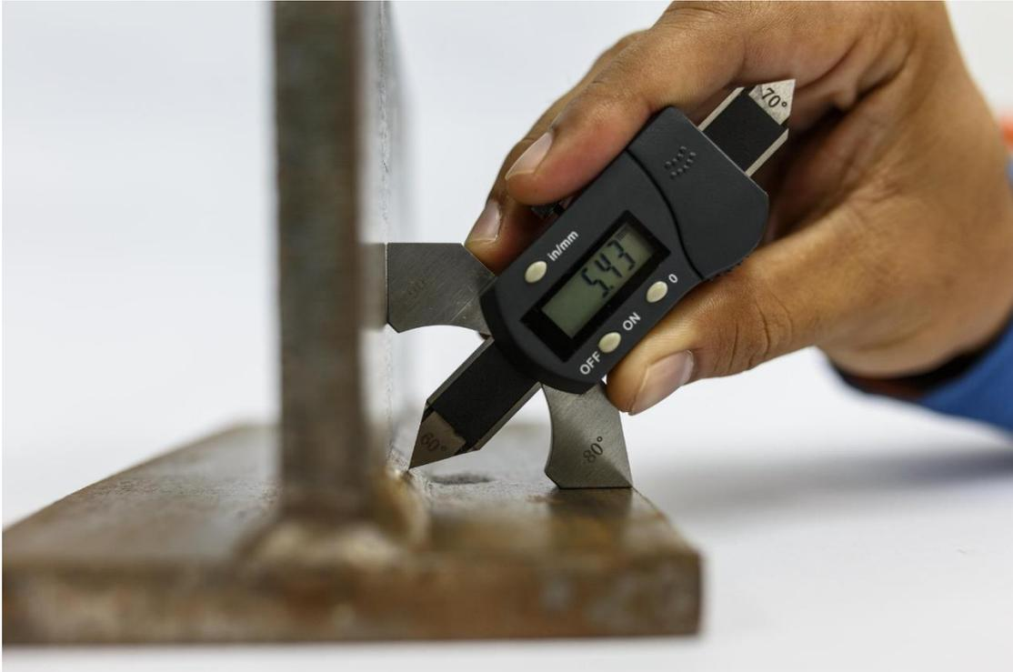
*Imagen 3. 8. Medición del espesor de una soldadura en T con un calibre. Fuente: [33]*
