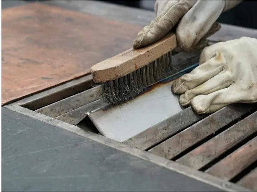
*Imagen 3. 4. Limpieza manual del cordón de soldadura con cepillo de alambre.*
