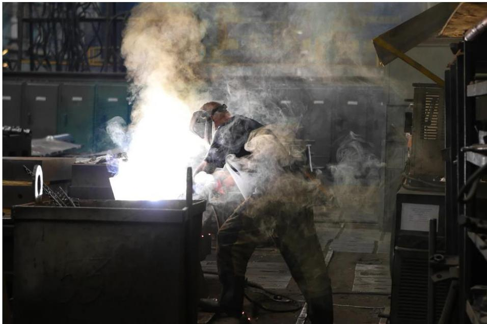
*Imagen 3. 6. Trabajo de soldadura sin la extracción de humos conveniente. Fuente: [32]*
