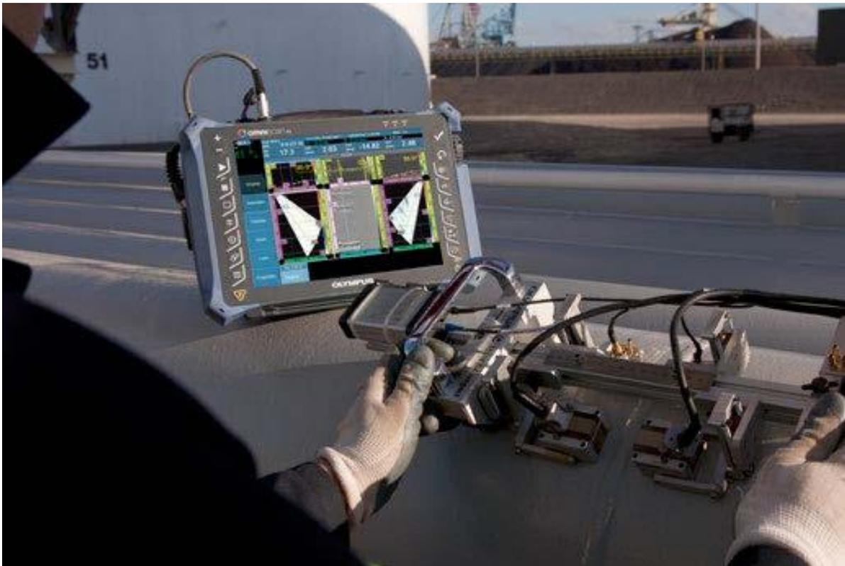
*Imagen 2. 19. Inspección por ultrasonidos Phased Array (PAUT).*
