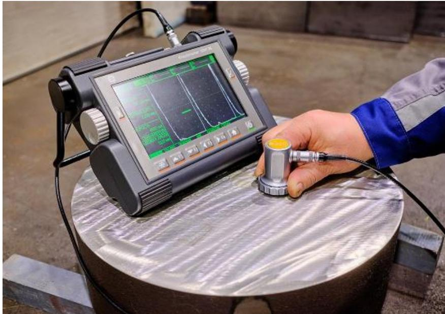
*Imagen 2. 16. Equipo de medición de ultrasonidos.*
