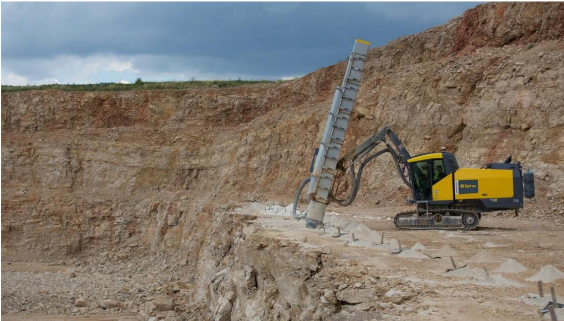
*Imagen. Perforadora eléctrica SmartROC T35 de Epiroc*
