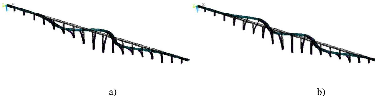
Figura 10-3 Modo 3: a) 0.543 Hz; Modo 4: b) 0.617 Hz de vibración lateral del puente Arroyo de las Piedras
