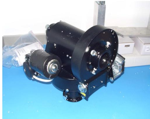
Figura 3.15: Sistema de motores AZ/EL empleado en el Radiotelescopio de la UPCT
