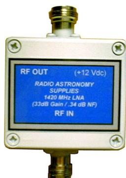
Figura 3.18: LNA empleado en el Radiotelescopio de la UPCT
