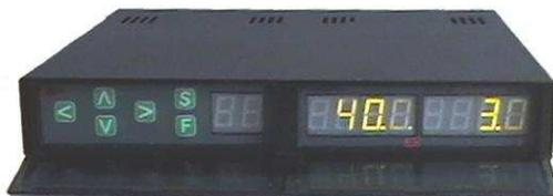
Figura 3.16: Controlador del sistema de motores empleado en el Radiotelescopio de la UPCT
