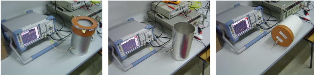
Figura 3.22: Testeo de las bocinas del Radiotelescopio de la UPCT
