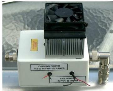
Figura 3.19: Sistema *cooler* de los LNAs del Radiotelescopio de la UPCT
