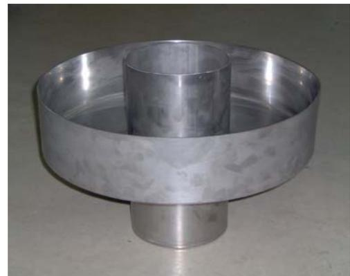
*Bocina optimizada para una antena parabólica de  $\phi=5m$   $f/D=0.3$ , fabricada y medida en la UPCT*
