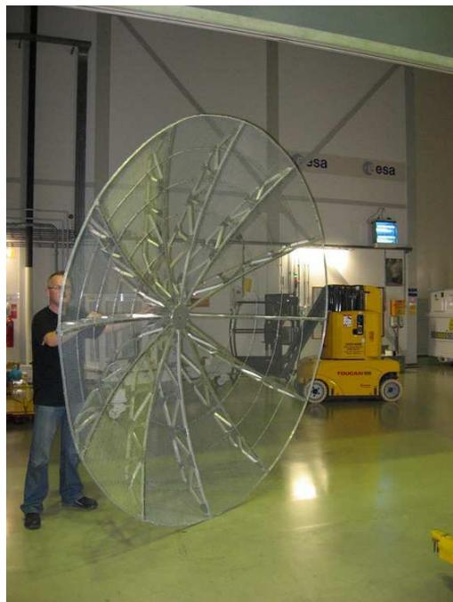
Figura 3.13: Reflector parabólico de 3 m de diámetro. Cortesía de RF HAMDESIGN
