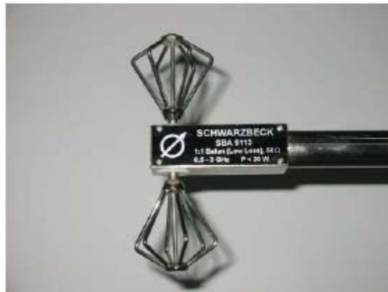
Con el fin de comprobar el correcto funcionamiento de la antena para el rango frecuencial citado, hemos medido su parámetro  $S_{11}$ , obteniendo los siguientes resultados.
