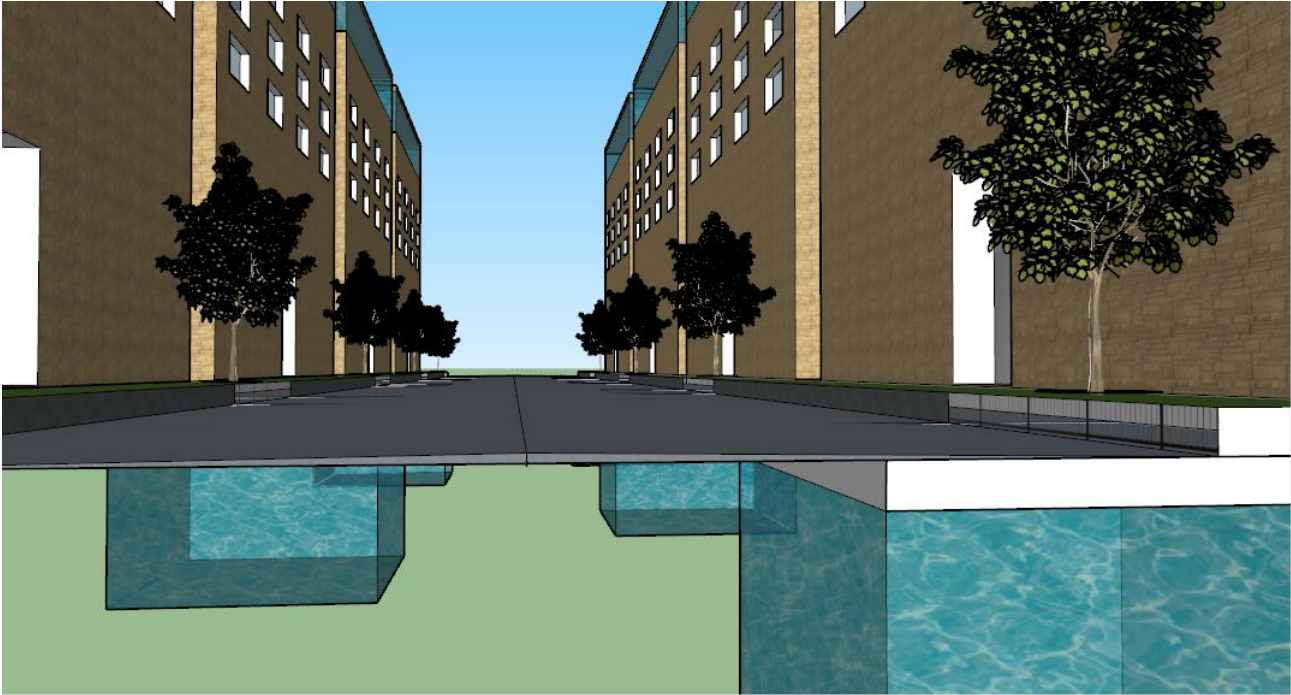
Figura 25 - Detalle del proyecto de la carretera con bombeo hacia los extremos. Realización con software de diseño 3D SketchUp.
