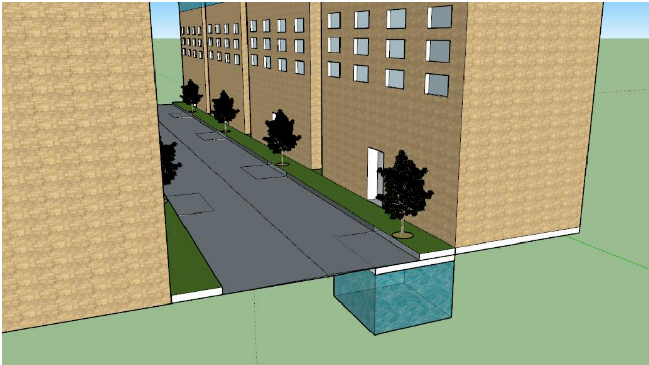
Figura 21 - Detalle del proyecto en el que se destaca una zanja filtrante con un sistema de bio-retención compuesto por árboles y un depósito subterráneo de agua de lluvia. Realización con software de diseño 3D SketchUp.
