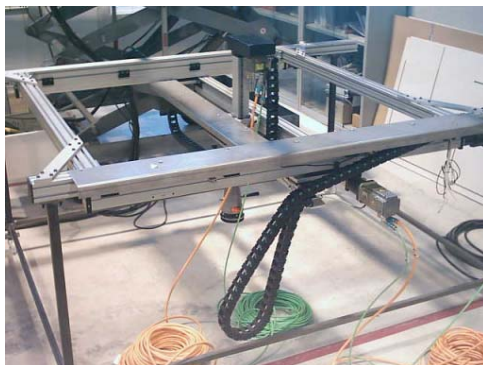
e) Mesa XYZ construida
