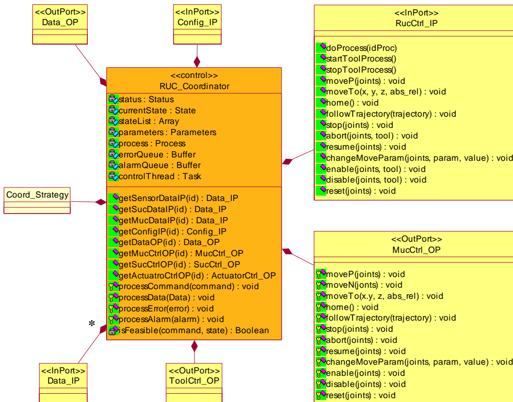
Fig. 7.21.- RUC_Coordinator: Coordinador del GOYA con un mecanismo y una herramienta
