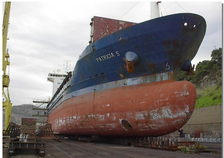
b) Casco de buque para chorrear sólo algunas zonas ("spotting")
