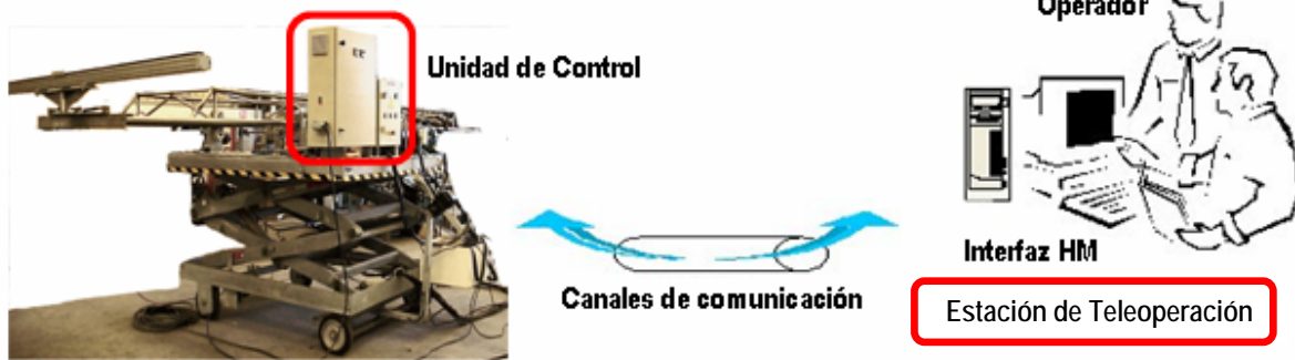
Fig. 4.12.- Elementos básicos de un sistema de teleoperación
