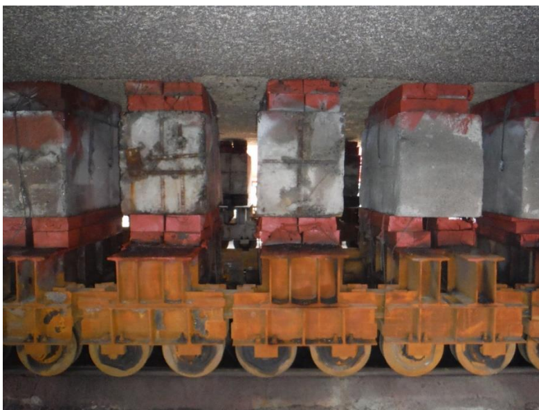
Figura 13: Detalle de Carro de varada Fuente: Inspector de ABS
