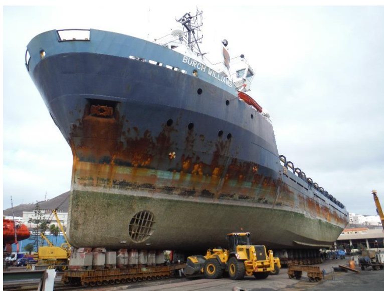
Figura 12: Buque encima de una cama de varada
