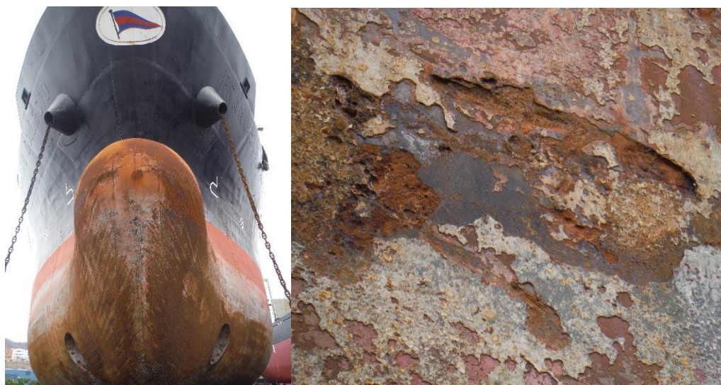
Figura 17: Imágenes de un casco con corrosión Fuente: Inspector de ABS
