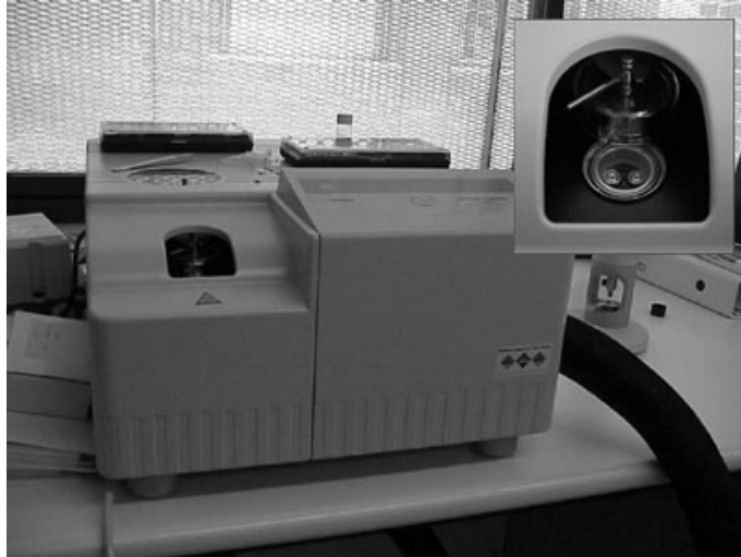
Figura 2.33. Calorímetro con detalle del horno.
