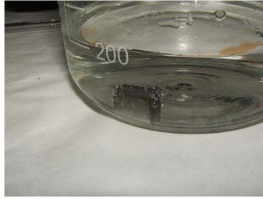
Figura 3.25. Vista del aluminio en el electrolito renovado (24h).
