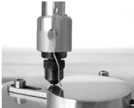
Figura 2.3. Punzón con bola de acero.
