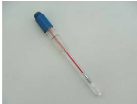
Figura 2.22. Electrodo de referencia Calomelanos XR100.
