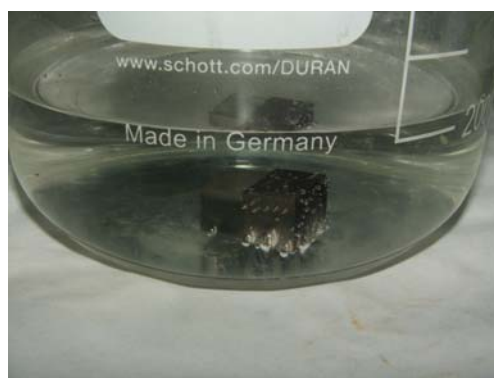
Figura 3.23. Vista del par aluminio/acero en el electrolito renovado (9h).
