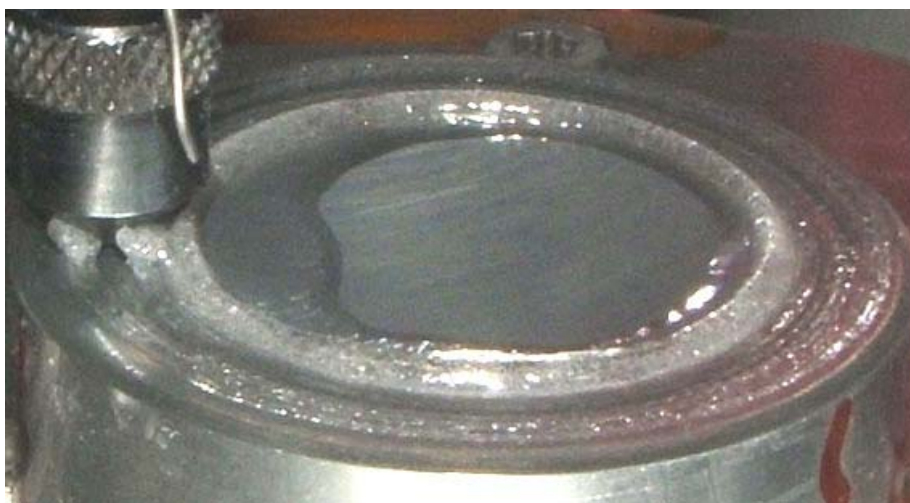
Figura 4.12. Detalle de la sustancia gelatinosa formada durante el ensayo.
