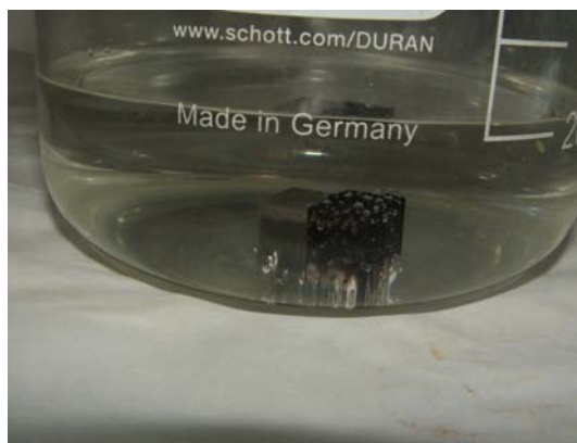
Figura 3.26. Vista del par aluminio/acero en el electrolito renovado (24h).
