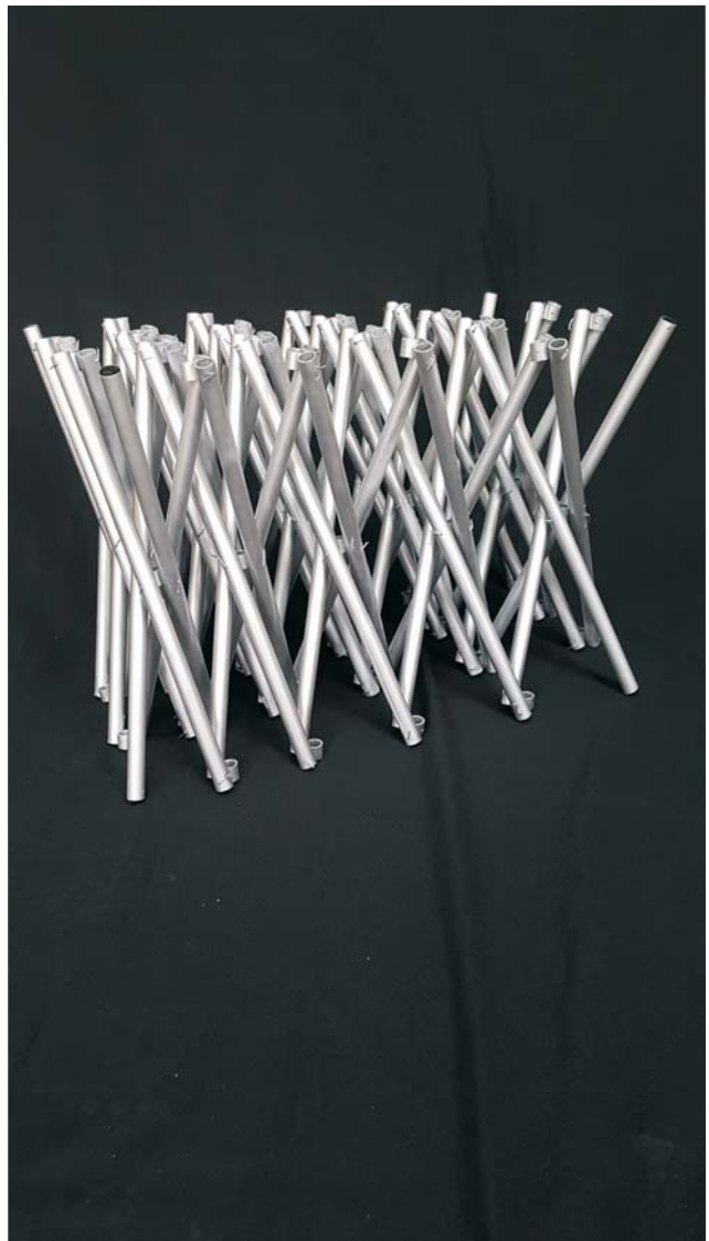
Composición basada en el módulo de Emilio Pérez Piñero (Patente ES266801/USA3185164). Estados: plegado y desplegado Modelización: Grasshopper/Kangaroo Construcción: barras y nudos de aluminio
