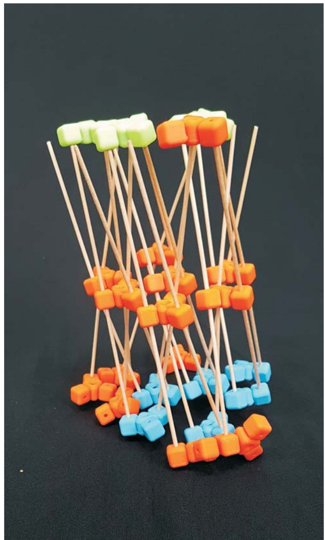
Composición basada en el módulo de Emilio Pérez Piñero (Patente ES266801/USA3185164) Modelización: Grasshopper/Kangaroo. Construcción: barras de madera y nudos mediante impresión 3D con plástico ABS.
