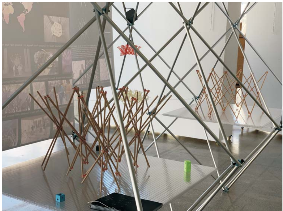
4.3_Soporte: Paneles de metacrilato apoyados sobre los tensores de la estructura actúan como soporte para los modelos de menor tamaño.
