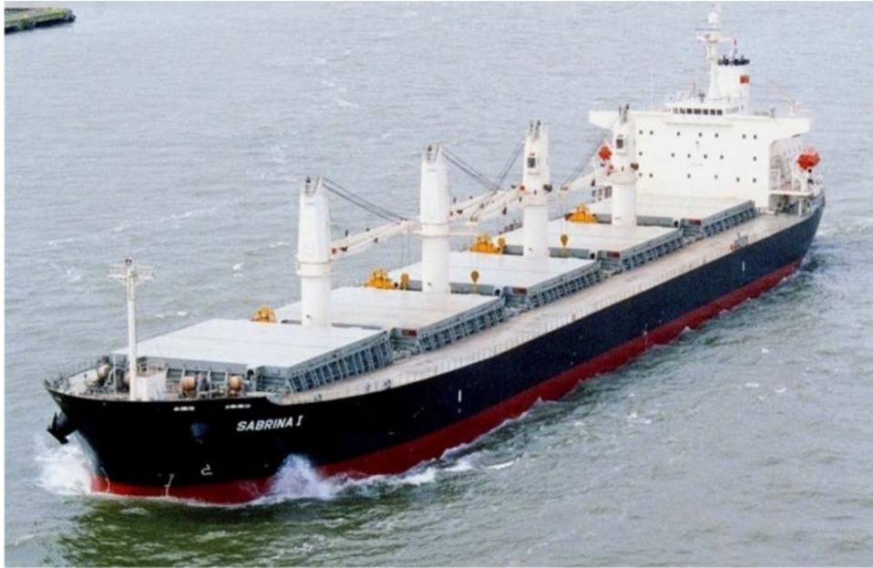
Figura 1.4: Granelero con grúas de a bordo en navegación. Fuente: Wikipedia
