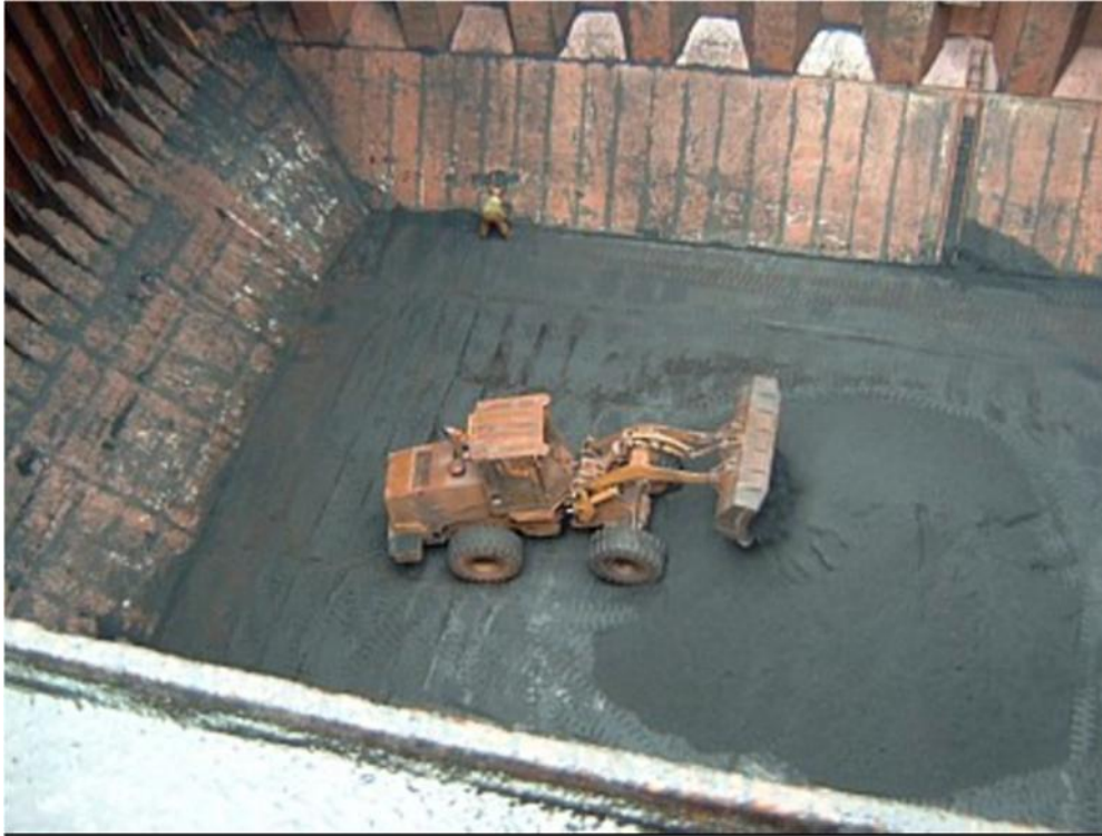
Figura 1.13: Apilado de carga en bodega. Fuente: stevesmaritime.com
