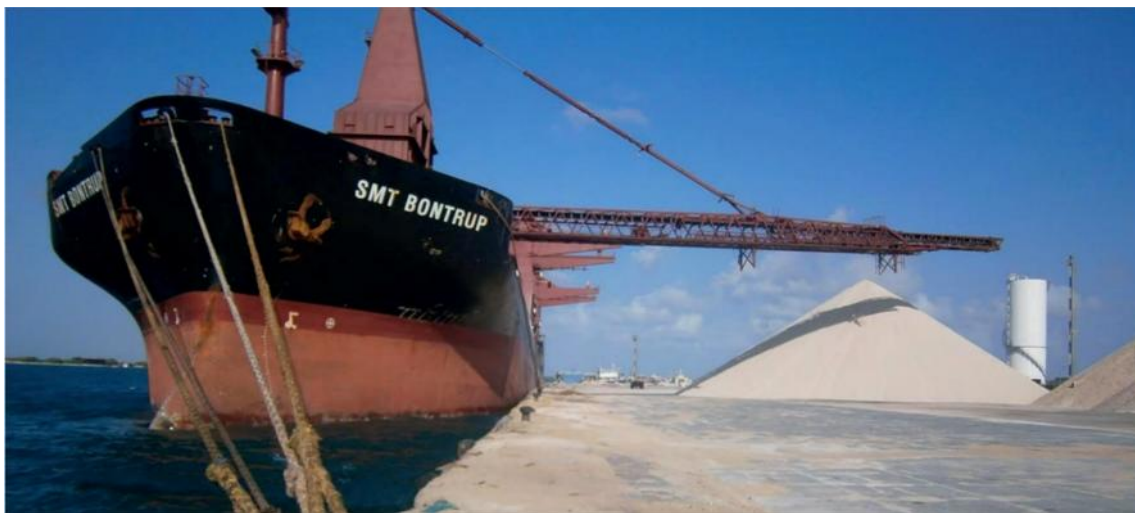
Figura 1.8: Descarga de granelero por cinta transportadora. Fuente: Marine Traffic
