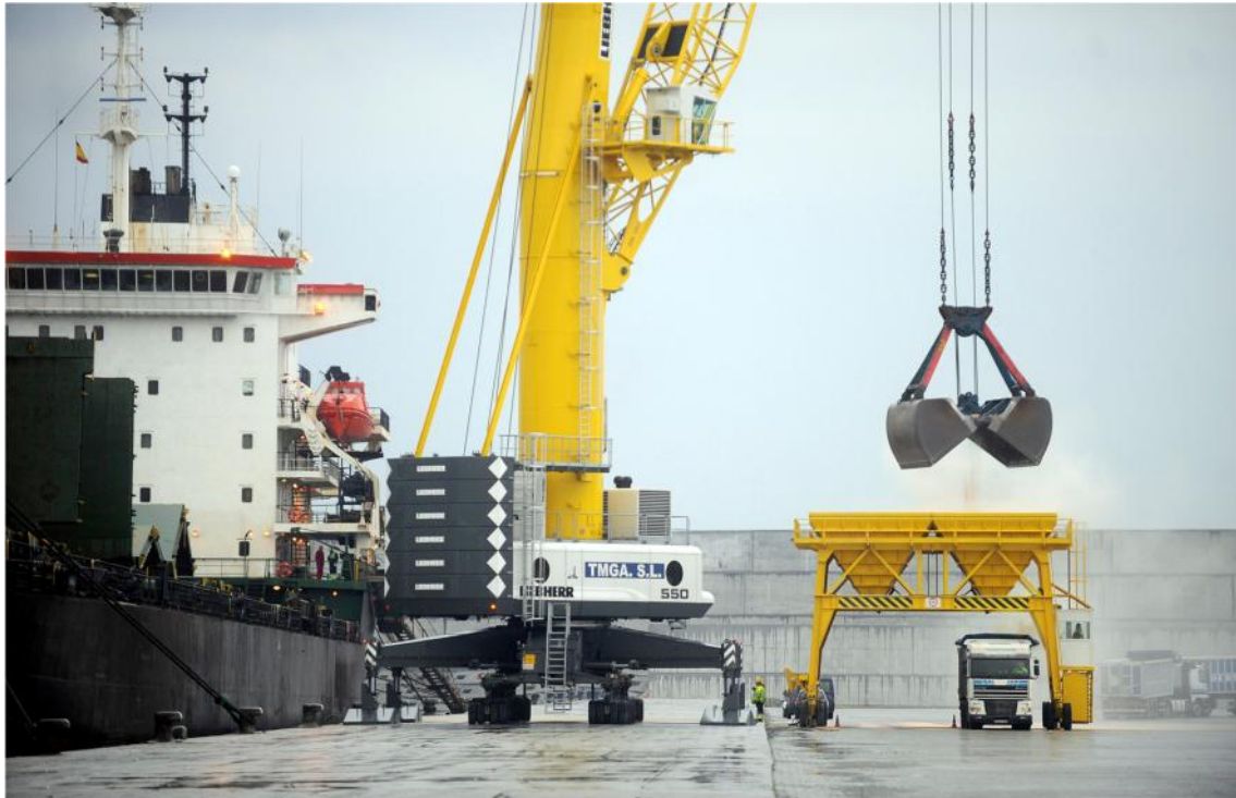
Figura 1.10: Grúa de puerto descargando en silos. Fuente: Autoridad Portuaria de A Coruña
