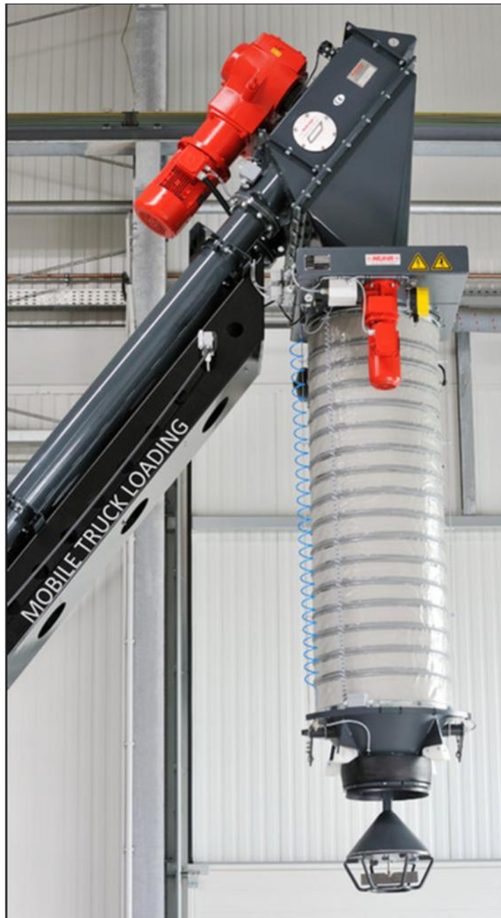
Figura 1.9: Detalle de manga neumática de aspiración. Fuente: schrage.de
