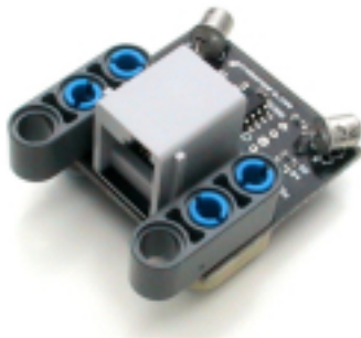
Imagen 2.3: Imagen del detector de obstáculos de Mindsensors
