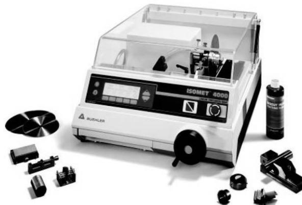
**Figura 2.15.** Cortadora de precisión.
