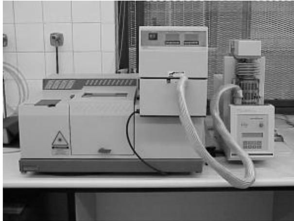
**Figura 2.21.** Espectrómetro infrarrojo.
