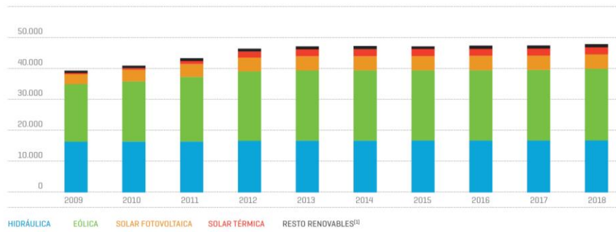
Figura 9 Estructura de potencia instalada del Sistema eléctrico nacional en términos porcentuales a fecha de 31/12/2018. Fuente Red Eléctrica de España (REE).
