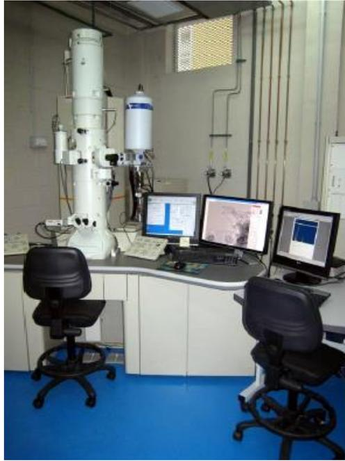
*Figura 3.17. Microscopio electrónico de transmisión Jeol JEM-2010.*
