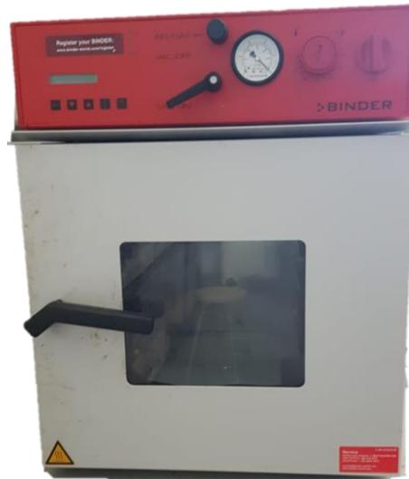
Figura 3.7 Estufa de vacío BINDER ATP VD 23.
