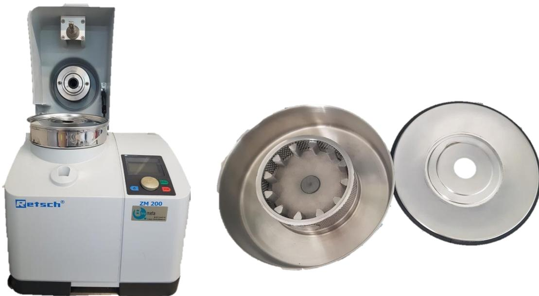
Figura 3.6. Molino RETSCH, modelo ZM 200 con detalle de las cuchillas.
