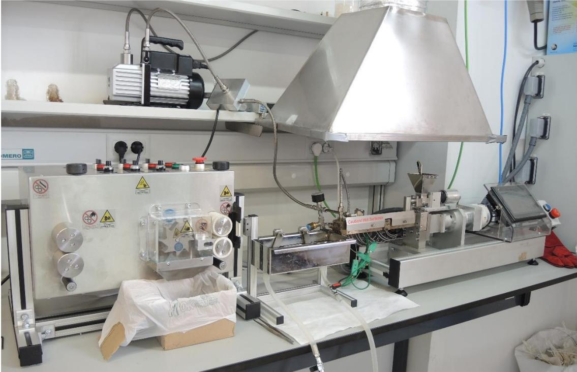
Figura 3.8. Línea de microextrusión TwinLab 10 mm.
