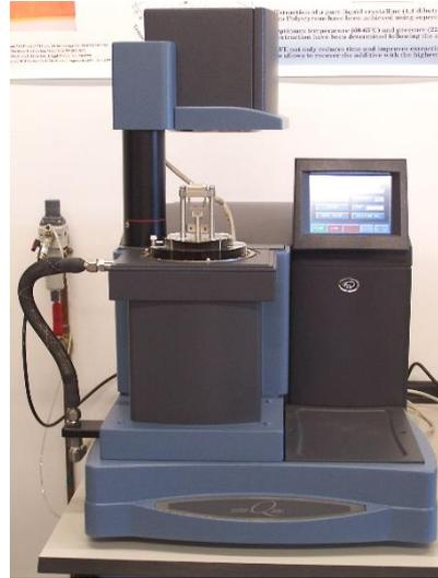
Figura 3.23. Analizador dinámico-mecánico DMA Q800 de TA Instruments.
