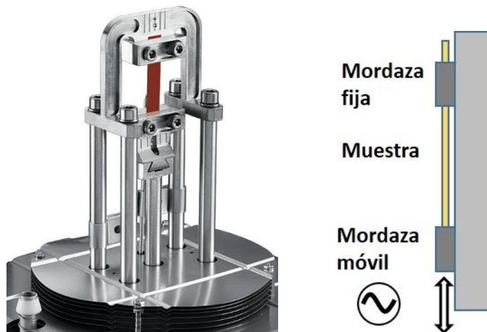
Figura 3.28. Modo de deformación en viga a tracción.
