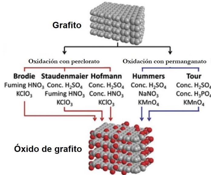
Figura 1.2. Esquema de los distintos métodos de oxidación del grafito [18].
