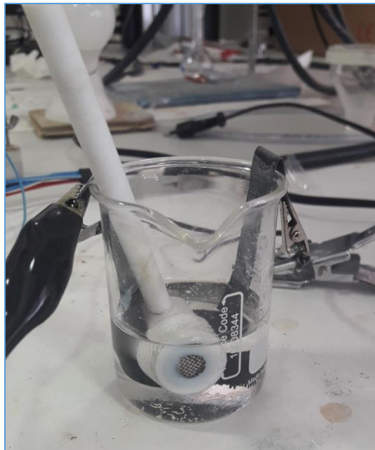
Ilustración 9: Batería líquida abierta durante un ensayo
