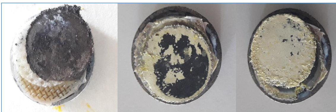
Ilustración 24: Diferentes estados del Bismuto durante los ensayos. De izquierda a derecha: Descarga completa, carga parcial y carga completa.
