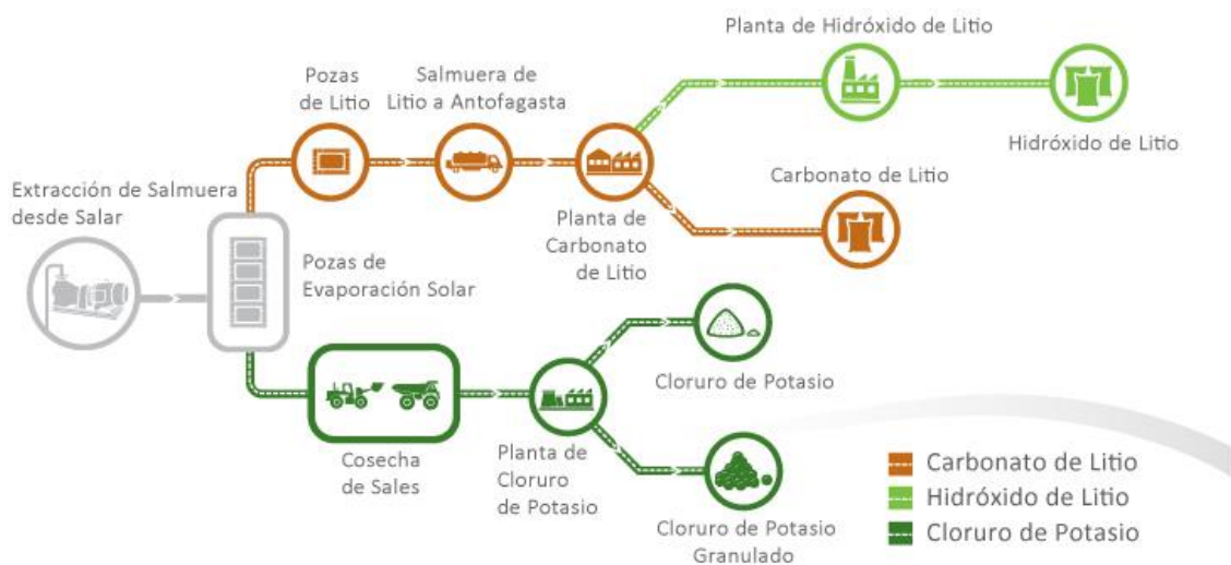
Ilustración 37. Proceso de transformación del litio, SQM
