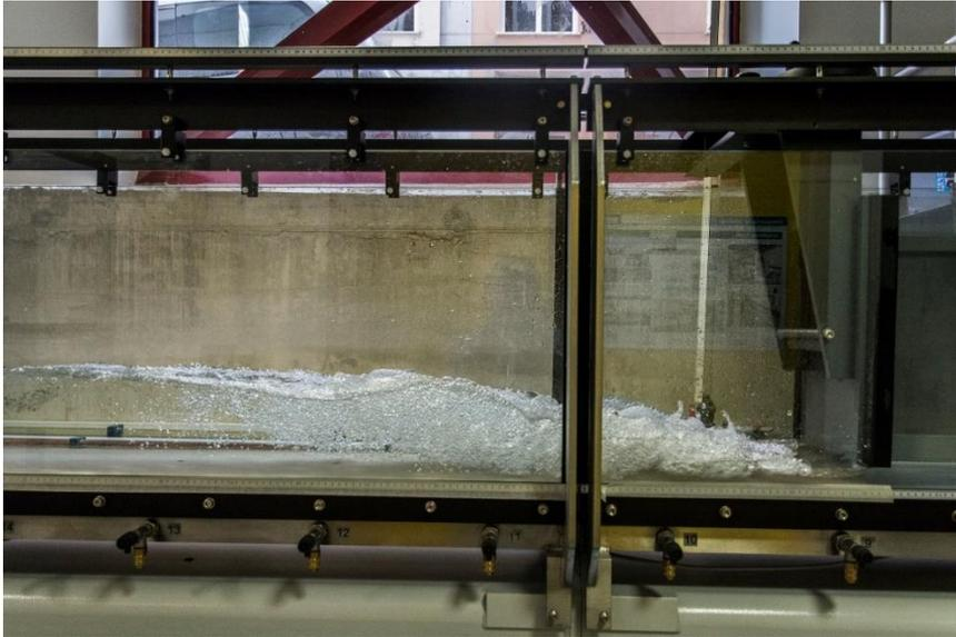
Figura 3. 15. Resalto hidráulico obtenido en laboratorio
