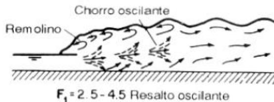
Figura 3. 24. Esquema del resalto oscilante. (Ven Te Chow, 2000)
