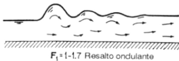
Figura 3. 22. Esquema del resalto ondulante. (Ven Te Chow,2000)
