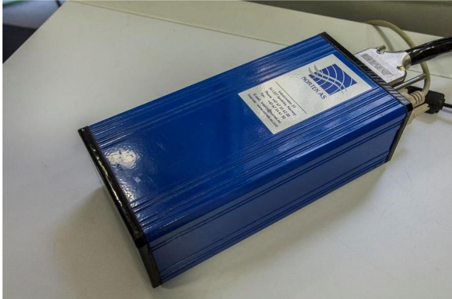
Figura 4. 12. Módulo de procesamiento de la señal del equipo ADV.
