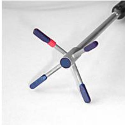
Figura 4. 14. Sonda ADV con cuatro receptores.
