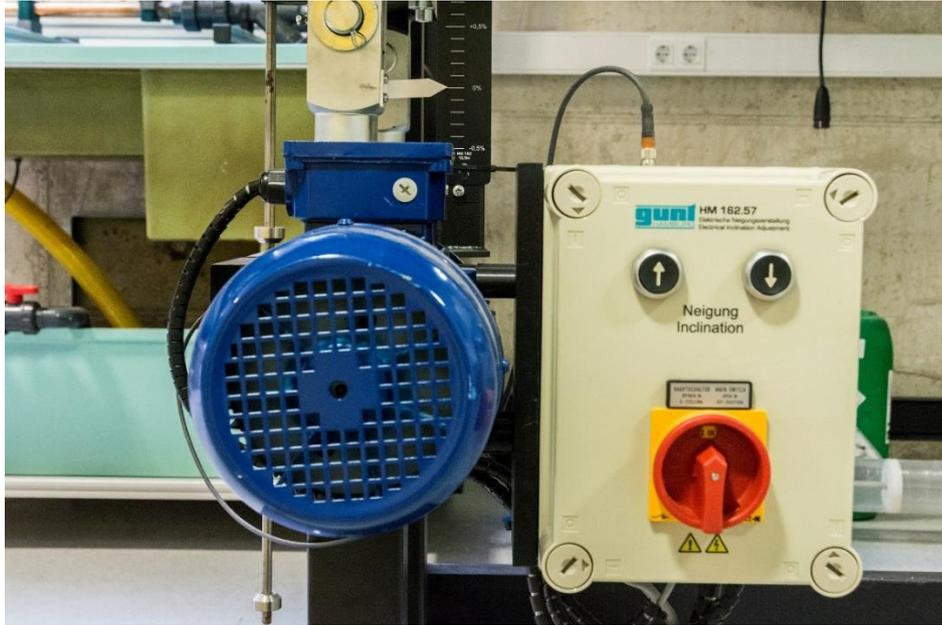
Figura 4. 4. Mecanismo de variación de la pendiente longitudinal.
