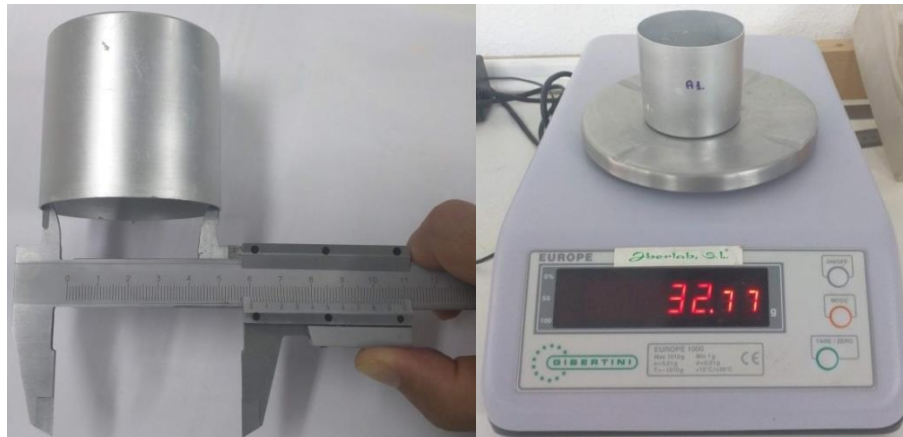
Figura 19. Medidas y masa del molde cilíndrico vacío.
