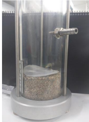
Figura 33. Filtro de malla metálica tras filtro de arena.
