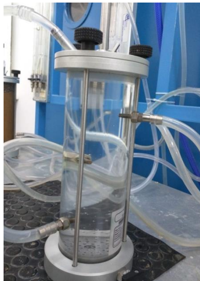
Figura 30. Prueba de estanqueidad.
