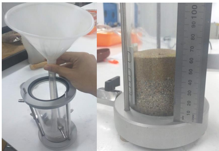
Figura 34. Vertido de la muestra por tongadas.
