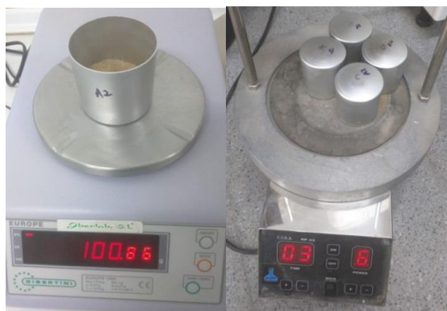
Figura 21. Compactación mediante vibrador de la muestra.
