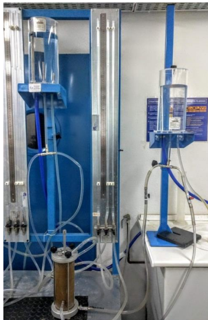
Figura 39. Gradiente hidráulico final.
