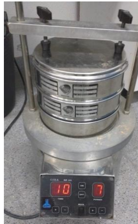
Figura 31. Cribado de grava para filtro.
