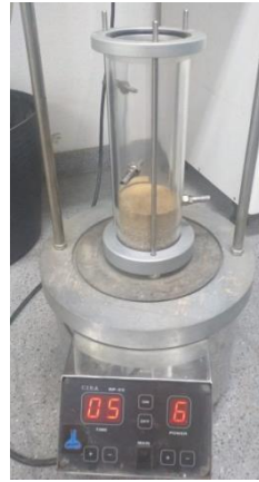
Figura 35. Vibrado de las tongadas.
