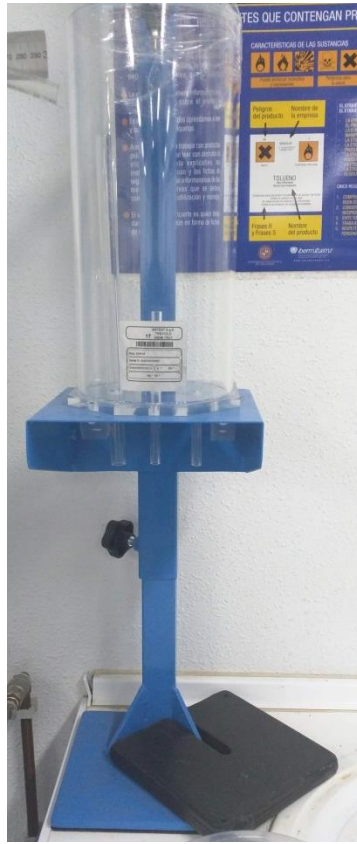
Figura 26. Depósito de agua desaireada.
