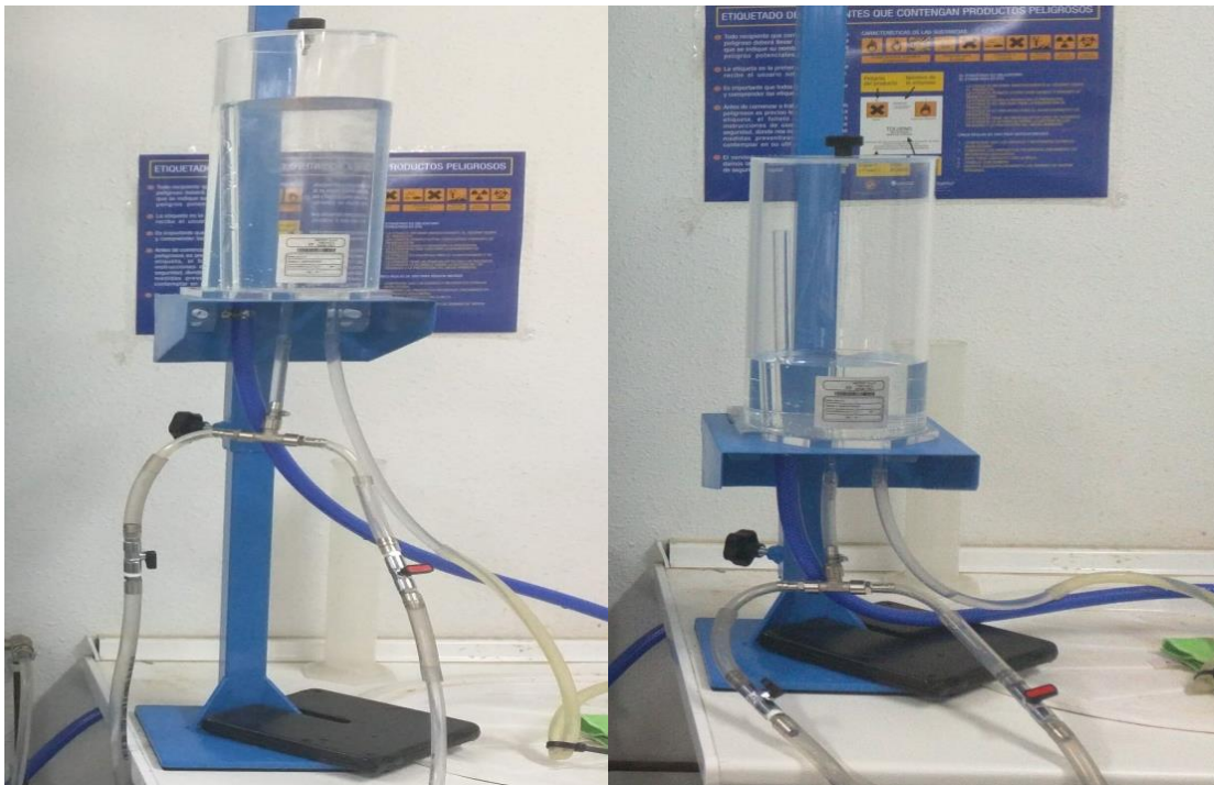
Figura 29. Depósito de agua desairada a distintas alturas junto con conexiones.
