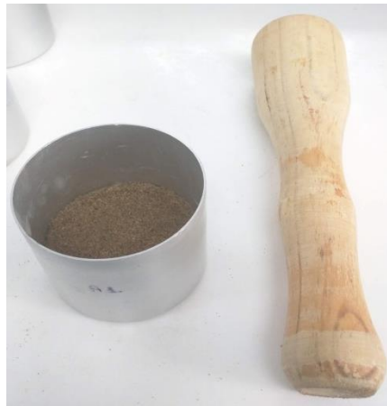
Figura 22. Tongada compactada junto con maza.
