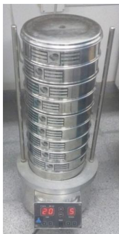
Figura 14. Tamices con muestra en el vibrador.
