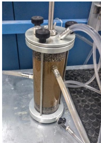
Figura 42. Permeámetro con muestra de arena suelta.
