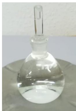
Figura 17. Picnómetro lleno hasta línea de enrase con cuello.
