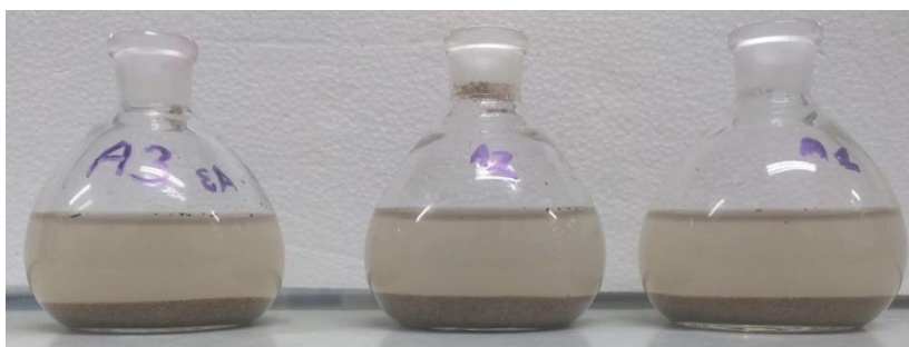
Figura 18. Picnómetros con muestra llenados a mitad.
