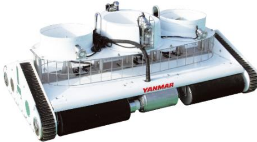
Imagen 5-29. Robot limpiador sumergible para redes en piscifactorías. Fuente: Yanmar
