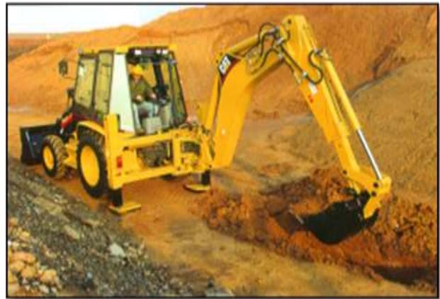
*Figura 22: Retroexcavadora*
