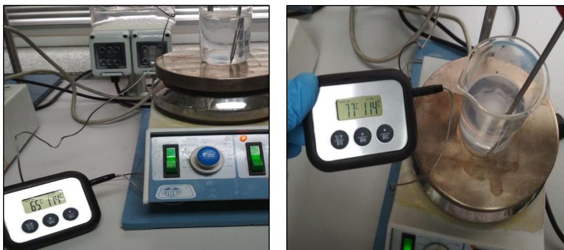
Figura 4.6. Punto de nube del emulsionante EN14.
