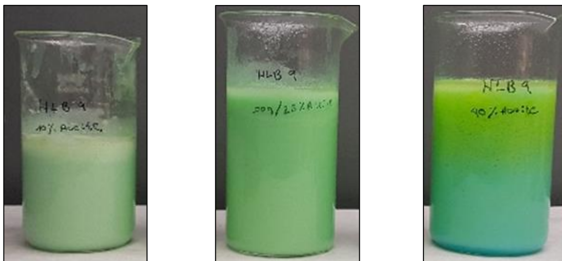
Figura 4.45. Emulsiones con 10%, 20% y 40% de aceite tras una hora de reposo.
