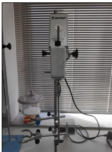
Figura 3.3. Agitador de varilla utilizado en laboratorio.
