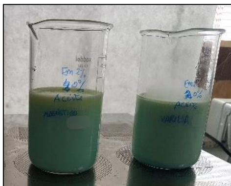
Figura 4.41. Estado inicial de las emulsiones al detener la agitación y a 50°C.
