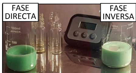
Figura 4.31. Situación de las emulsiones tras 15 minutos de agitación.
