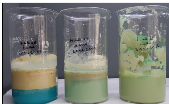
Figura 4.51. Estado de las mezclas con surfactantes EN 8 y EN 14 y cera carnauba.
