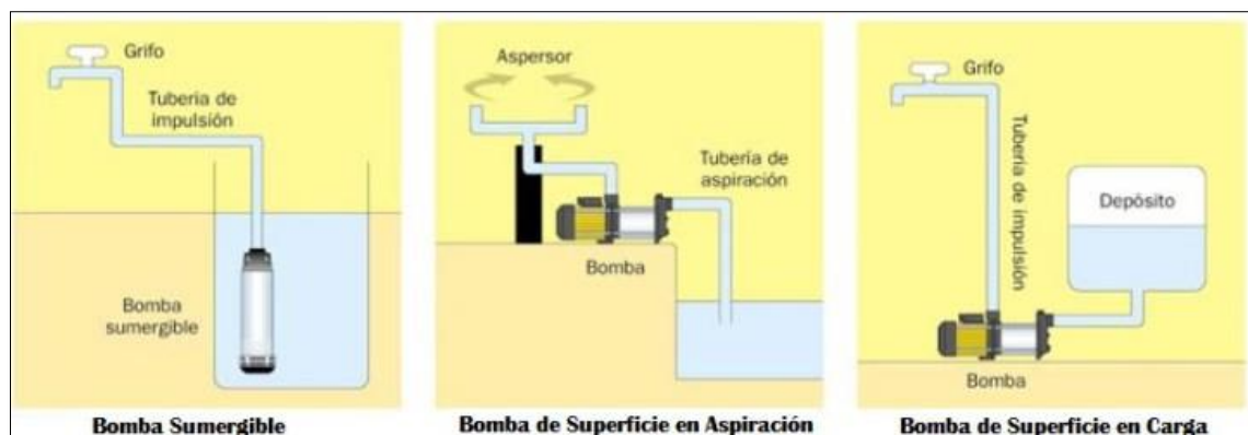
Figura 7.11. Clasificación de las bombas según su emplazamiento
