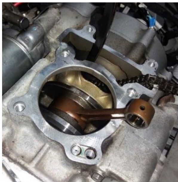
Ilustración 1.2.2.4.7. Detalle de la biela y parte del cigüeñal.
