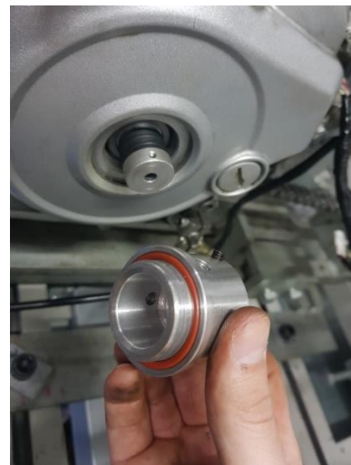
Ilustración 1.5.3.3. Soporte de fijación del encoder.
