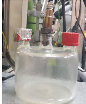
Ilustración 1.6.2.7.2. Dispositivo de calibración de la sonda lambda.
