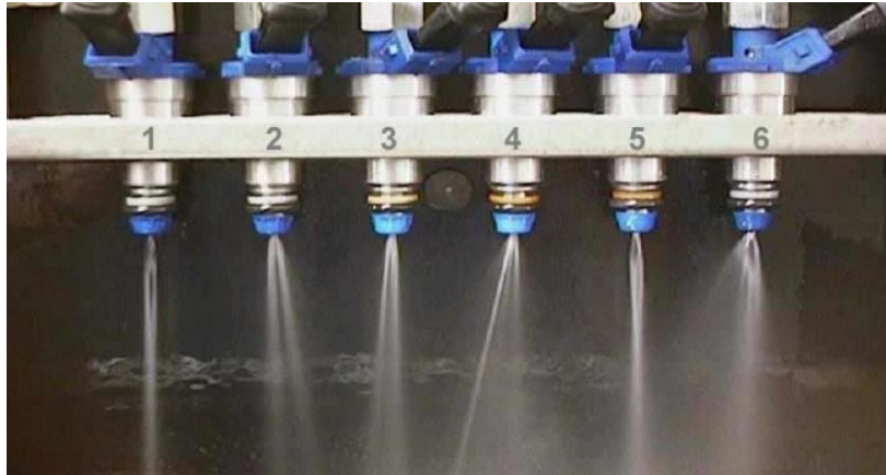
Ilustración 1.4.8.3. Flujo de combustible en inyectores.
