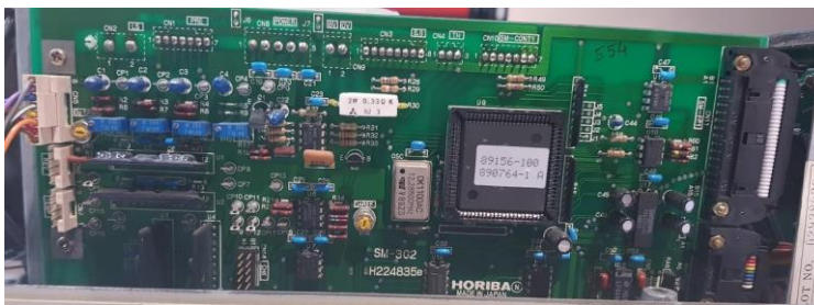
Ilustración 1.6.2.6.1. Circuitería para calibración del analizador de gases.
