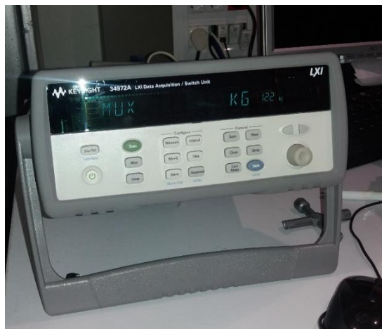
Ilustración 1.6.1.7. Datalogger empleado en los ensayos.
