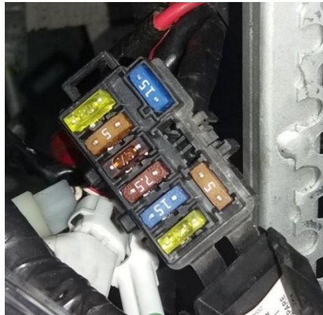
Ilustración 1.2.2.3.1. Fotografía de la caja de fusibles del motor.
