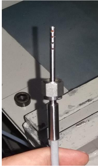
Ilustración 1.4.1.4. Constitución de la termorresistencia.
