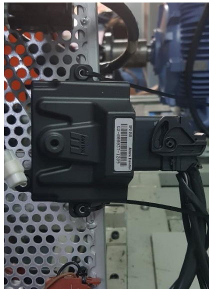
Ilustración 2.1. Centralita programable adquirida para la realización del proyecto.
