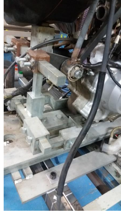
Ilustración 1.1.4.6. Imagen real del soporte trasero del motor.
