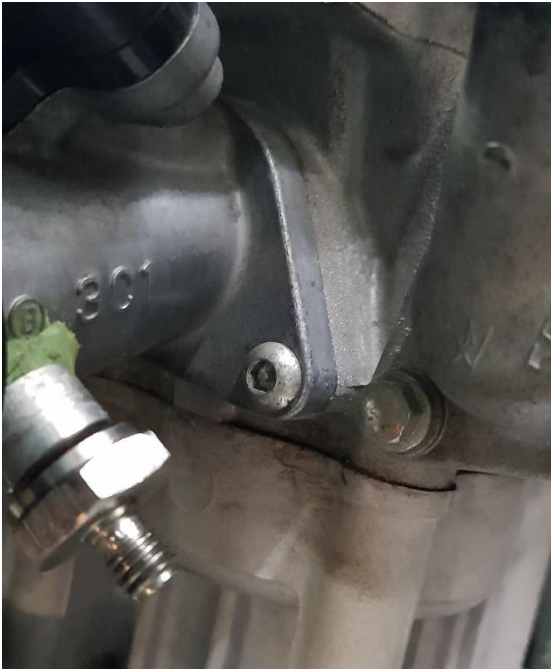
Ilustración 1.5.1.3. Toma para la instalación de la termorresistencia Pt100.
