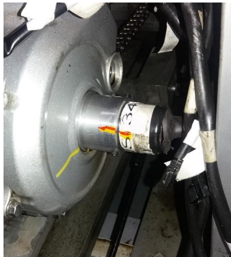
Ilustración 1.4.4.2. Encoder empleado en los ensayos.
