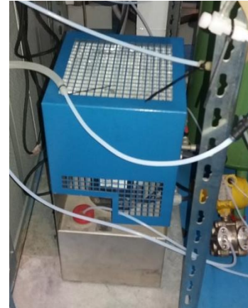
Ilustración 1.6.1.6. Bomba del circuito de refrigeración del transmisor de presión del tubo de escape.
