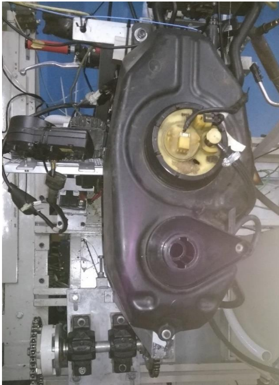
Ilustración 1.5.4.1. Depósito de gasolina.
