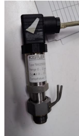
Ilustración 1.4.2.5. Nuestro transmisor de presión en el tubo de escape.
