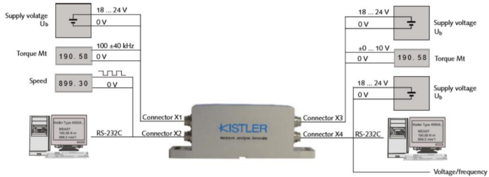
Ilustración 1.6.2.8.1. Esquema de conexiones del torquímetro.
