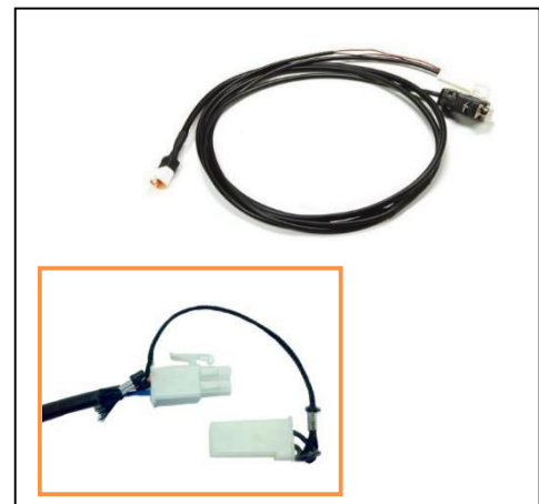
Ilustración 2.4.5. Desconexión del interruptor de programación.
