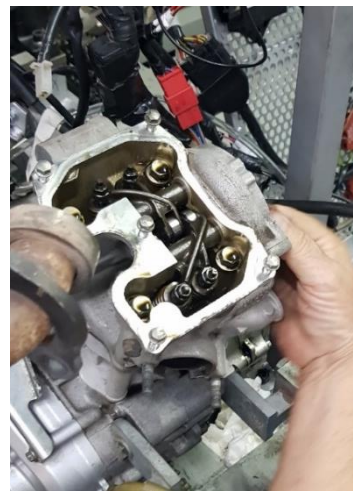
Ilustración 1.2.2.4.4. Imagen real de las válvulas.
