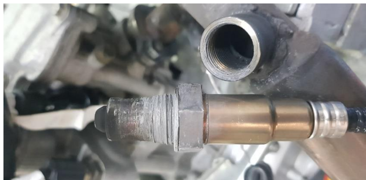
Ilustración 1.4.7.4. Constitución de la sonda.
