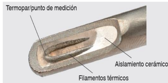
Ilustración 1.4.1.2. Constitución del termopar.
