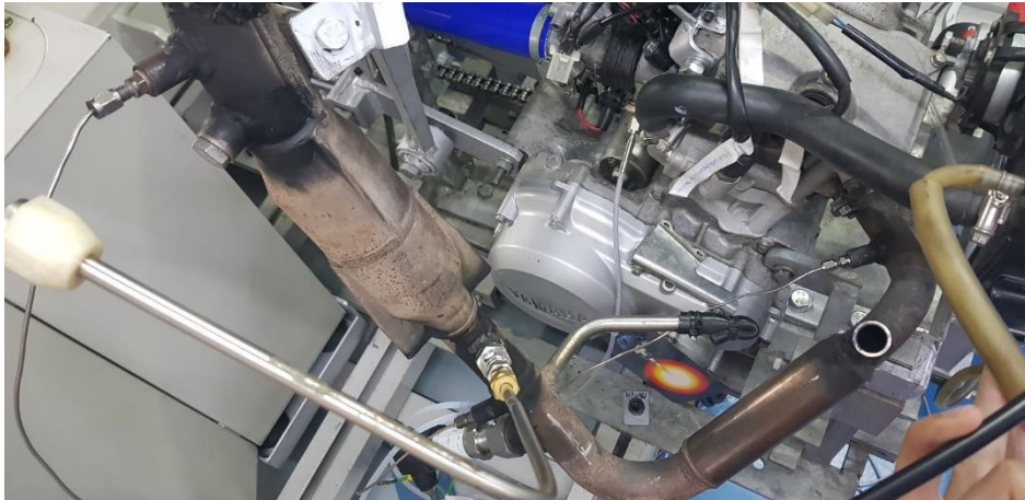
Ilustración 1.5.2.1. Tubo de escape con los sensores instalados.
