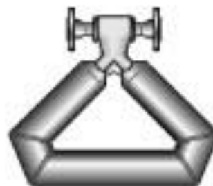
Ilustración 1.4.5.6. Medidor de flujo másico empleado y su esquema básico.
