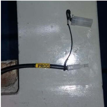
Ilustración 2.4.6. Cable de conmutación para el modo de programación.
