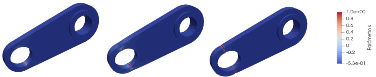
Figura 7.27. Propagación fractura ejemplo 4
