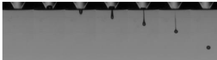
Figura 3.12 Proceso de expulsión de la gota paso a paso
