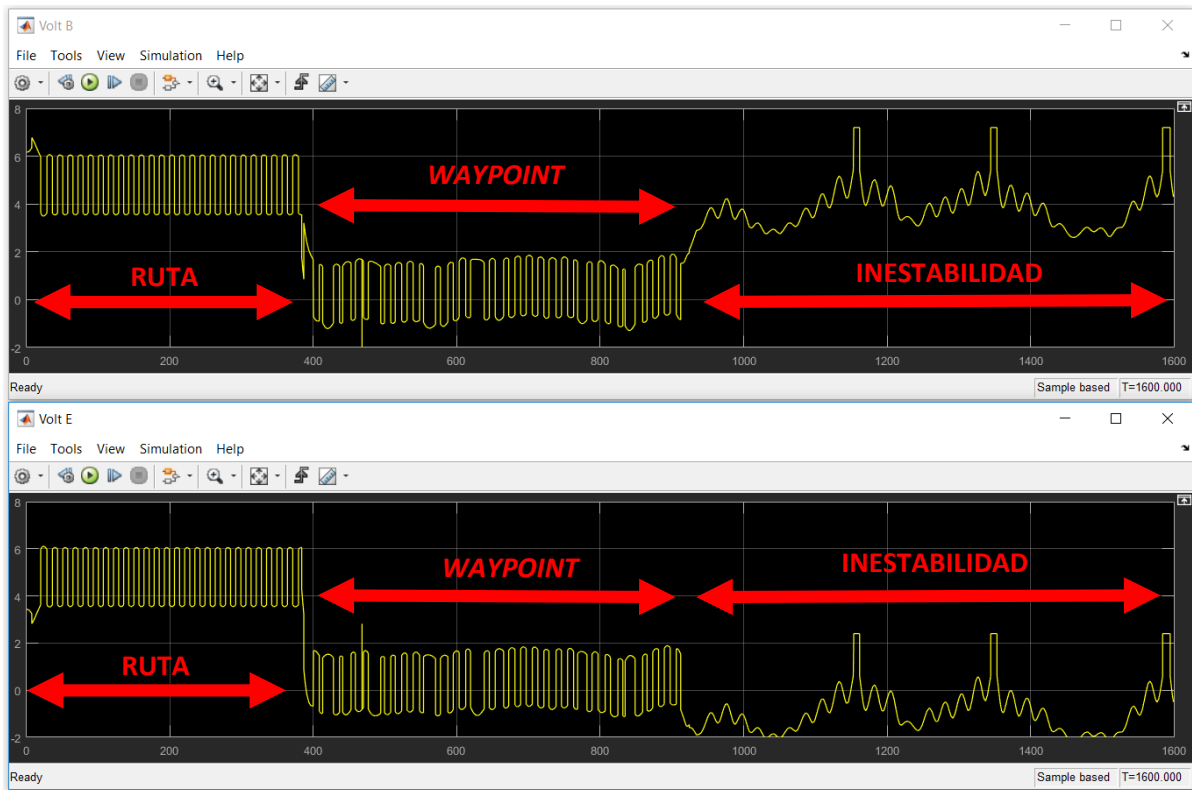
Figura 4.8. Variación de voltaje en los motores en modo autónomo.
