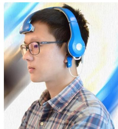
**Figura 39. Colocación dispositivo BR8 plus**
