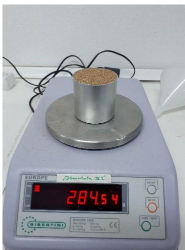
Figura 4.16. Masa del molde cilíndrico lleno.
