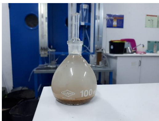
Figura 4.12. Picnómetro lleno con la porción y con el cuello puesto.
