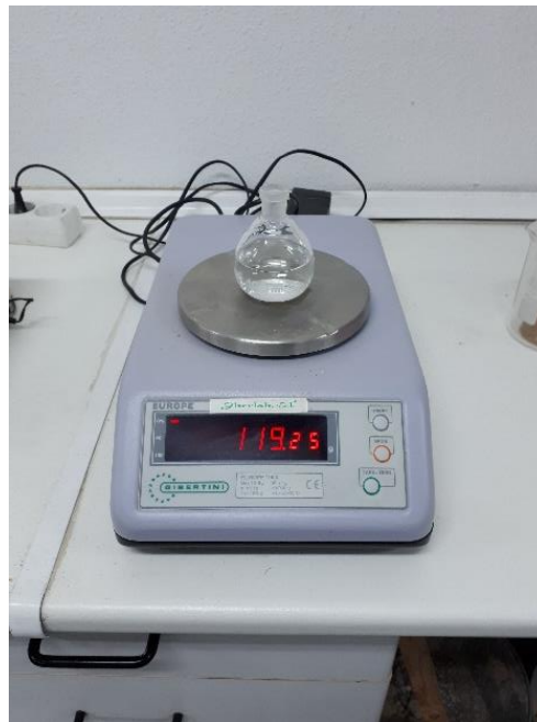
Figura 4.10. Masa del picnómetro lleno hasta la mitad sin cuello.
