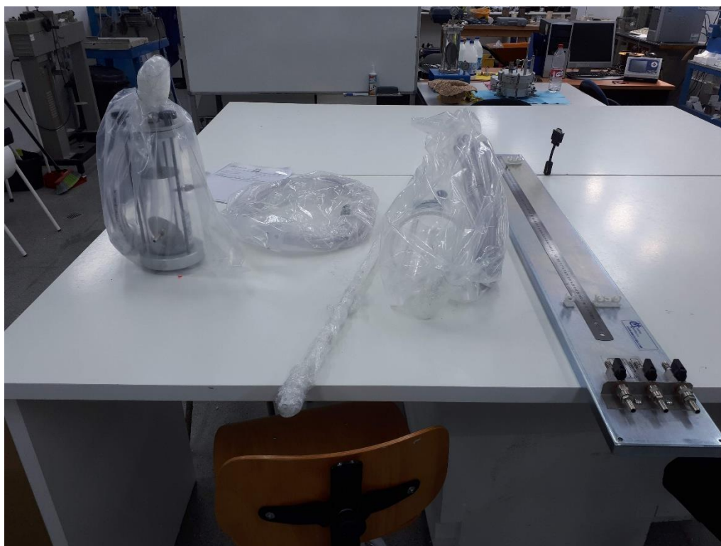
Figura 3.2. Diferentes piezas del permeámetro.
