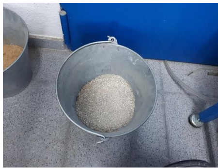
Figura 4.19. Material de gravilla del que se obtendrá el filtro.
