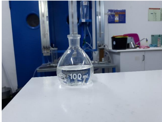
Figura 4.9. Picnómetro lleno hasta la mitad sin cuello.
