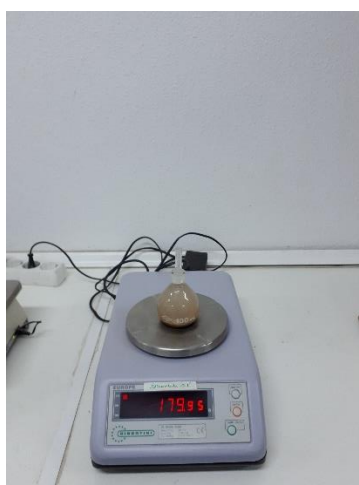
Figura 4.13. Masa del picnómetro lleno con la porción y con el cuello puesto.
