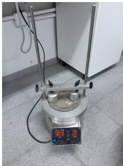
Figura 4.18. Dos moldes cilíndricos en agitador mecánico.
