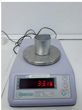
Figura 4.15. Masa del molde cilíndrico vacío.
