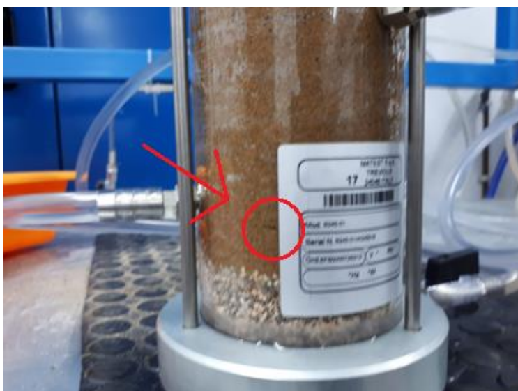
Figura 4.27. Grieta en la muestra dentro de la célula de permeabilidad.
