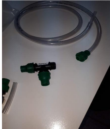
Figura 3.5. Unión plástica en forma de T unida a tubos flexibles.
