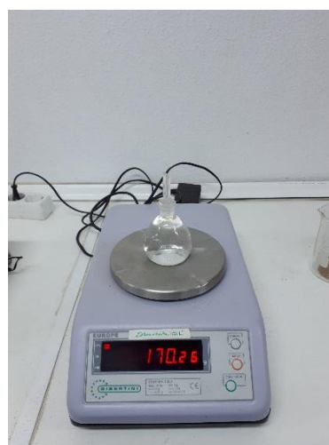
Figura 4.8. Masa del picnómetro lleno con cuello.
