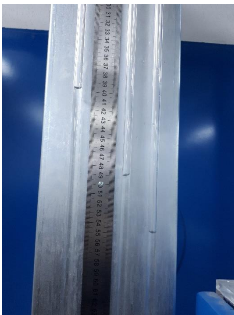
Figura 4.28. Lectura desigual de los piezómetros.
