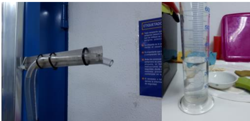
Figura 4.25. Descarga del permeámetro en la probeta.
