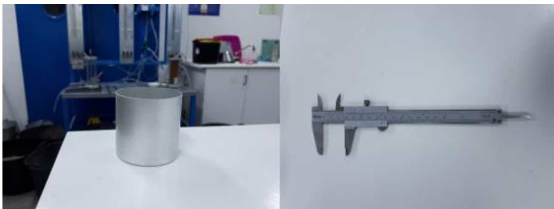
Figura 4.14. Molde cilíndrico de aluminio y calibre.
