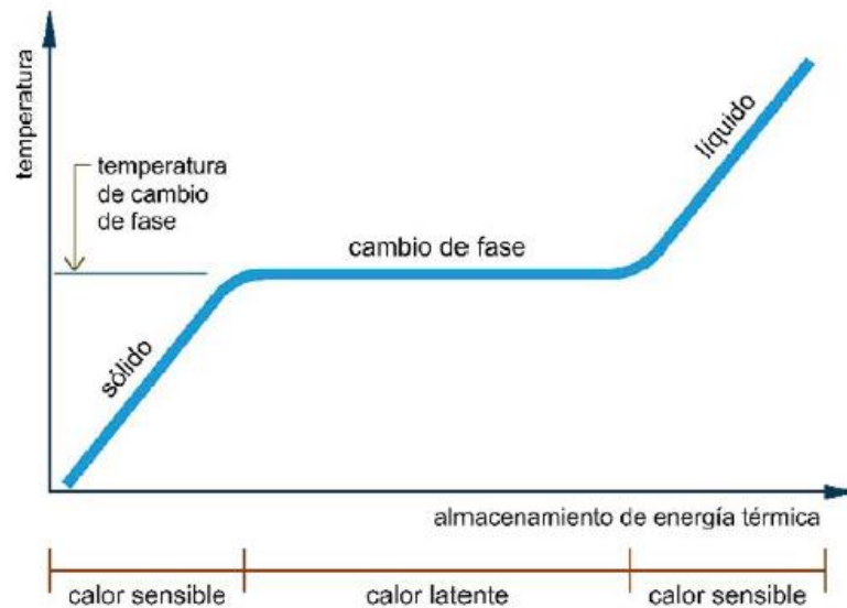
Figura 3. Relación almacenamiento energía- temperatura
