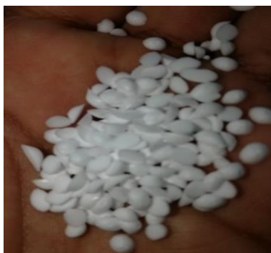
Figura 25. Formato comercial parafina RT70HC
