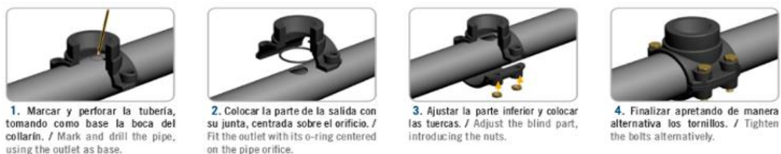
Figura 16. Detalle de montaje de los collarines para medida de la presión
