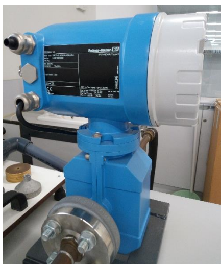
Figura 15. Caudalímetro electromagnético Endress+Hauser DN 15
