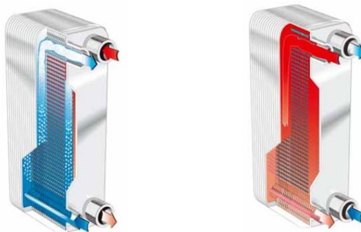
Figura 49. Direcciones de flujo del fluido caliente y frío.
