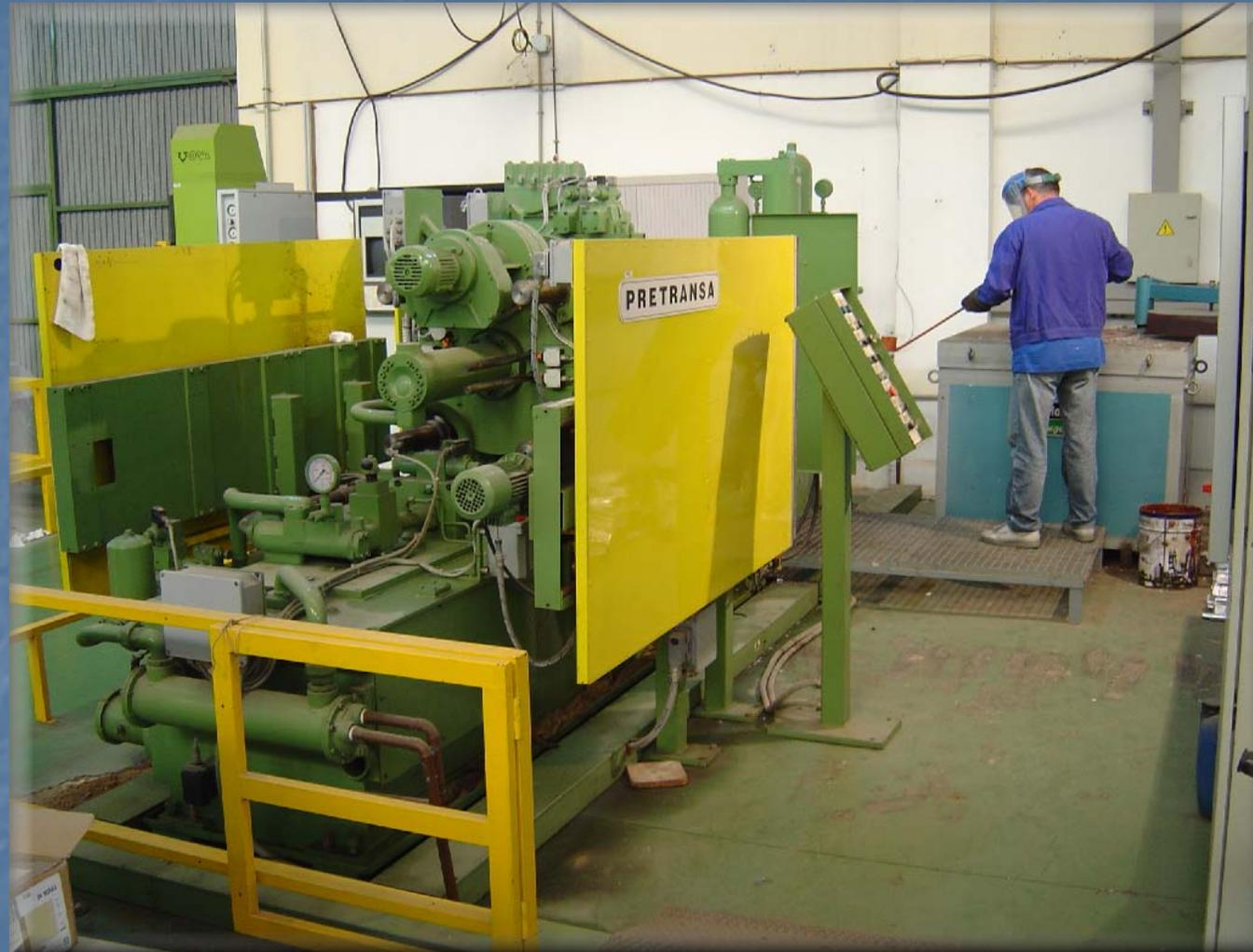
Máquina de fundición y horno de fusión
