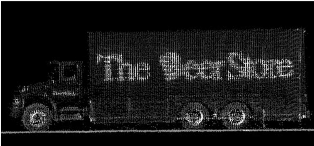
Figura 4.2 – Representación de una nube de puntos con valores de intensidad.
