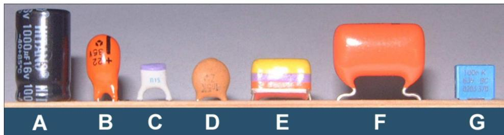
Figura A.2: Encapsulados típicos de condensadores: el tipo A es electrolítico; el tipo B es de tántalo; los tipos C y D (lenteja) son cerámicos; los tipos E, F y G son de polyester (plástico).
