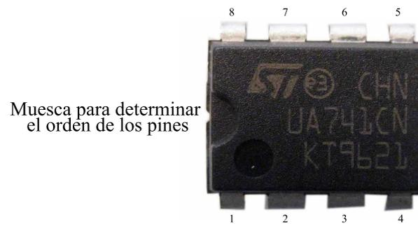
Figura 1.1: Imagen del encapsulado del circuito integrado 741. La muesca se utiliza para conocer el orden del patillaje.
