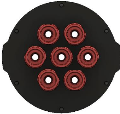
Figura 33 - Disposición de original de pasamuros
