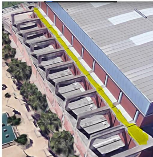
La zona marcada de amarillo es la que se recomienda para la instalación de colectores, también se podrían colocar en la parte baja con el inconveniente de las sombras que proyectan los pilotes, o crear una estructura metálica entre las columnas de hormigón y sobre ella colocar los colectores solares con el inconveniente de incremento de precio por obra civil.
