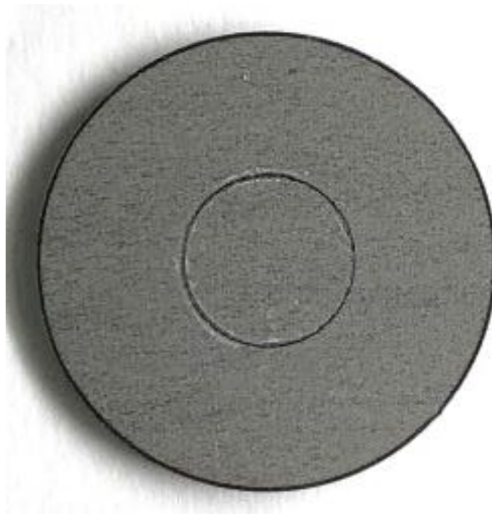
Figura 77. Disco del ensayo tribológico RE+9%L108_1C nº 1
