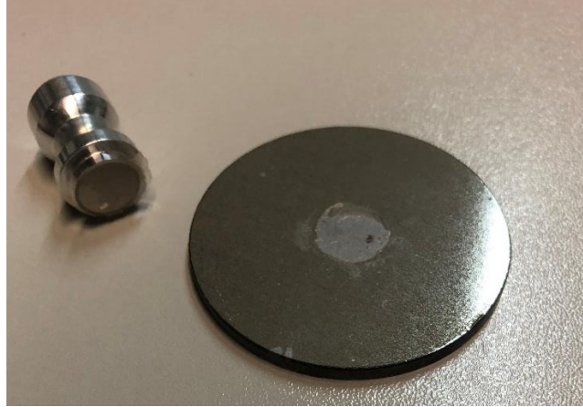
Figura 14. Sufridera y recubrimiento sobre disco de acero tras ensayo de adherencia
