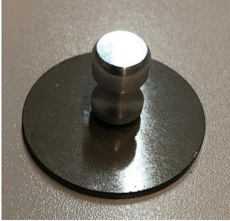
Figura 13. Sufridera y recubrimiento sobre disco de acero antes del ensayo de adherencia
