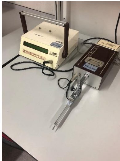
Figura 42. Rugosímetro Profilest SM-7
