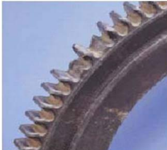
Figura 6. Desgaste por fatiga superficial
