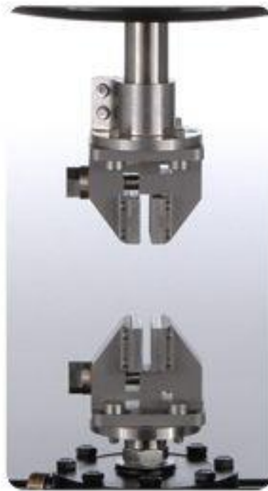
Figura 52. Mordazas equipo DMA
