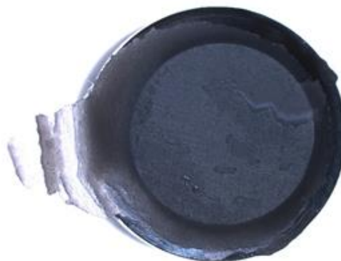
Figura 54. Sufridera con parte del recubrimiento ensayado arrancado satisfactoriamente. Escala 1:8,5
