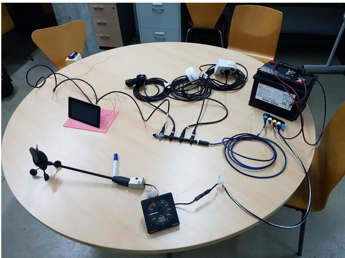
Figura 3.1. Esquema real que irá montado en el catamarán.
