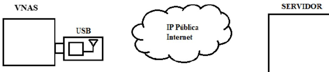
Figura 3.14. Comunicación inalámbrica a través de la red pública
