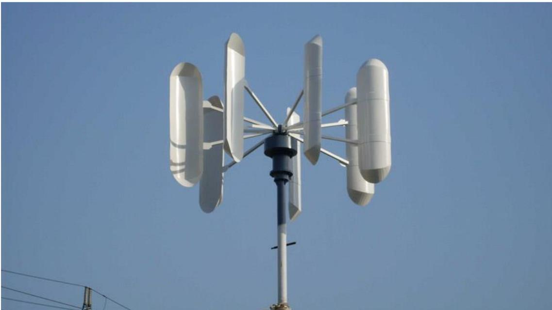
*Ilustración 36. Aerogenerador de eje vertical*
