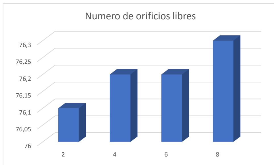
Figura 55: Gráfica según números de orificios libres de nuestro prototipo de medición de ruido.
