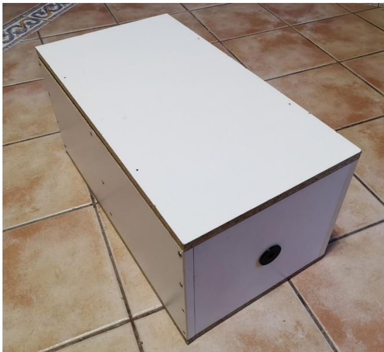
Figura 30: Cajón de madera de dimensiones 60x32x30 cm para el ensayo.
