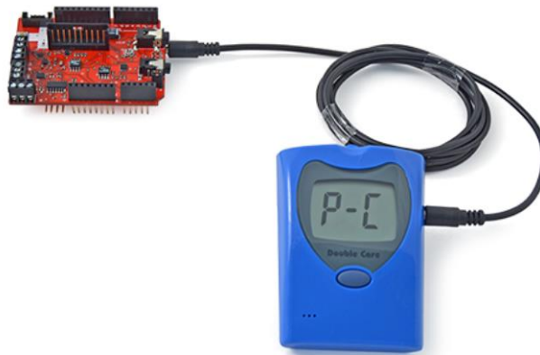
Ilustración 3.13.- Placa e-Health conectada al glucómetro
