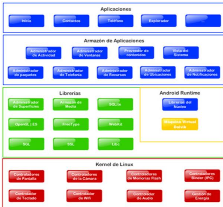
Ilustración 3.19.- Esquema de la arquitectura del sistema operativo Android
