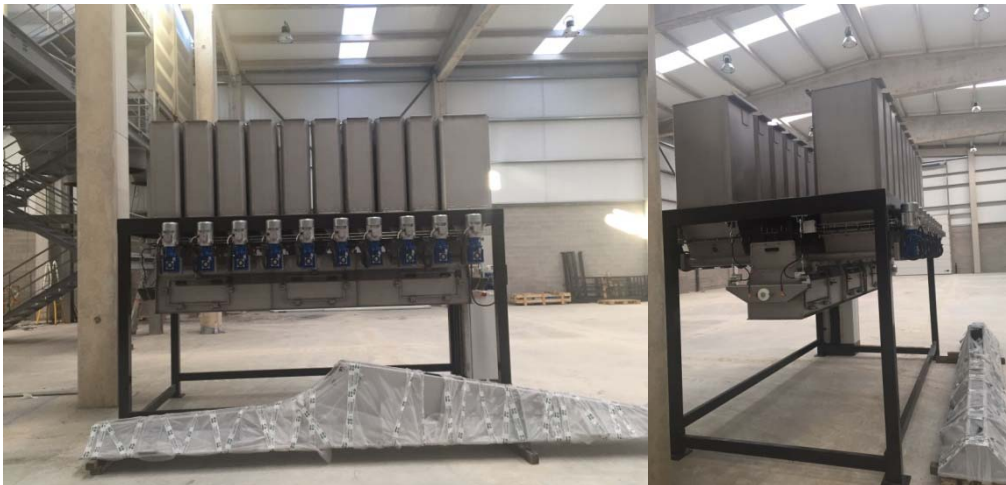
Figuras 48, 49. Batería de microdosificadores, vistas lateral y frontal
