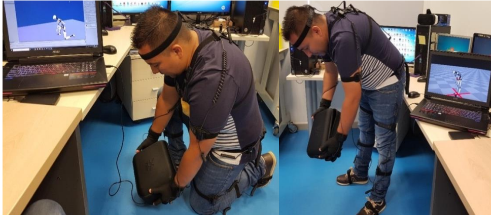
Figura 17. MOCAP en Tarea de Levantamiento Manual de Carga
