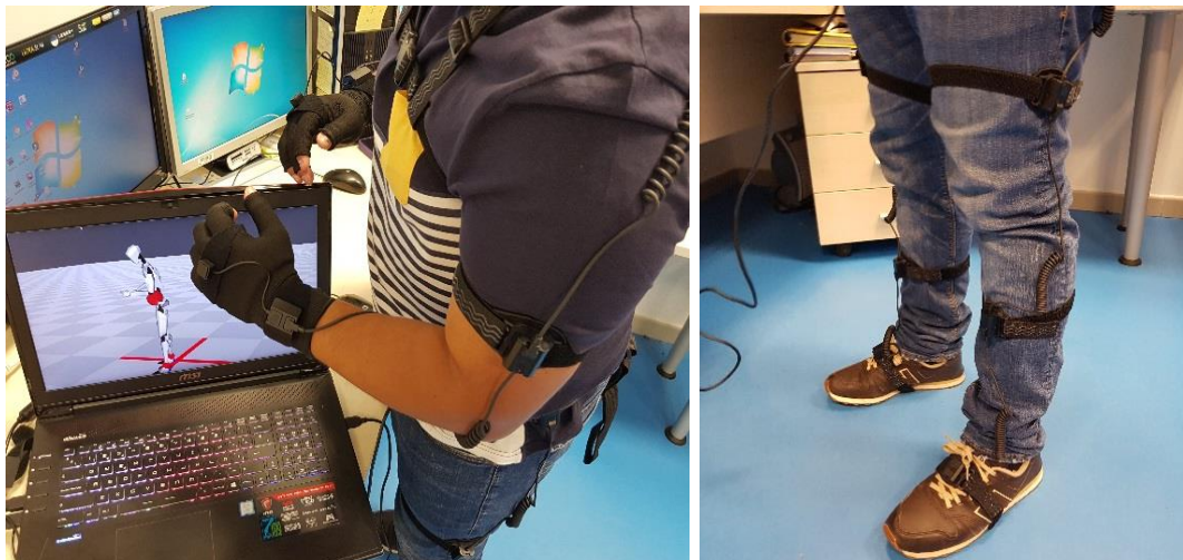
Figura 16. Calibración y Montaje de Traje Perception Neuron.
