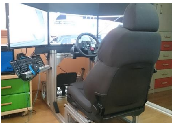
Figura 21. Simulador fijo 3 grados de libertad. Fuente: http://simulador-kaelh.blogspot.com
