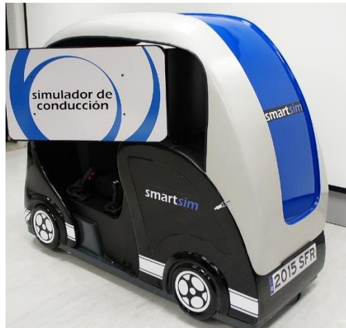
Figura 22. Simulador con cabina y plataforma de 6 grados de libertad. Fuente: http://simfor.es/wp/?portfolio=automovil
