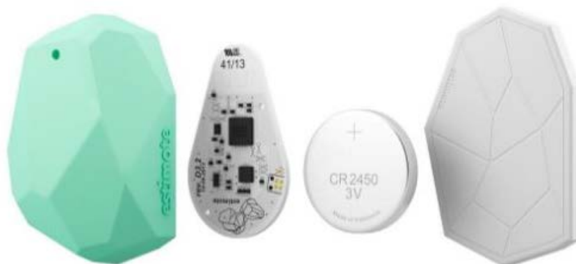
Figura 4. Partes de un Beacon, modelo Estimote.
