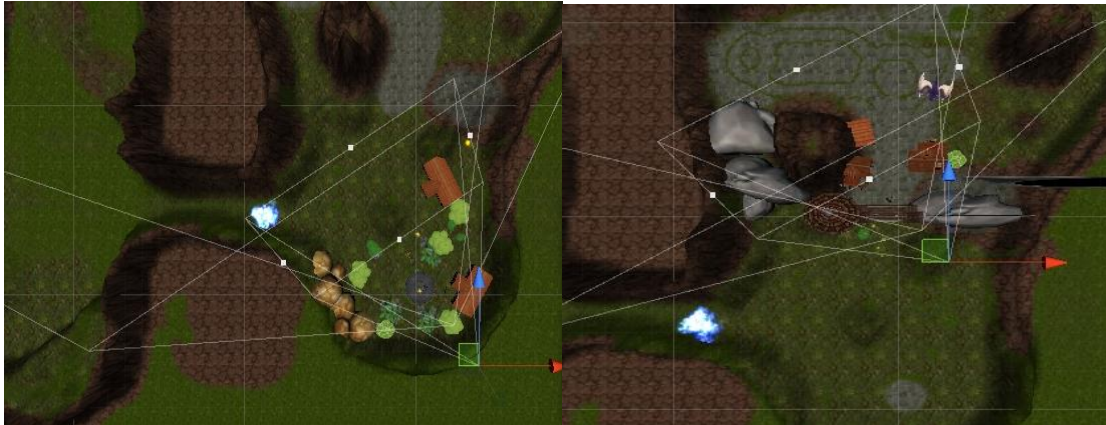
Figura 84: Demostración de cómo actúa la oclusión conforme el personaje se va desplazando.
