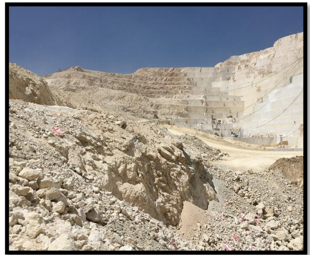
Ilustración 15. Banco a realizar el desmonte mediante voladura no eléctrica.
