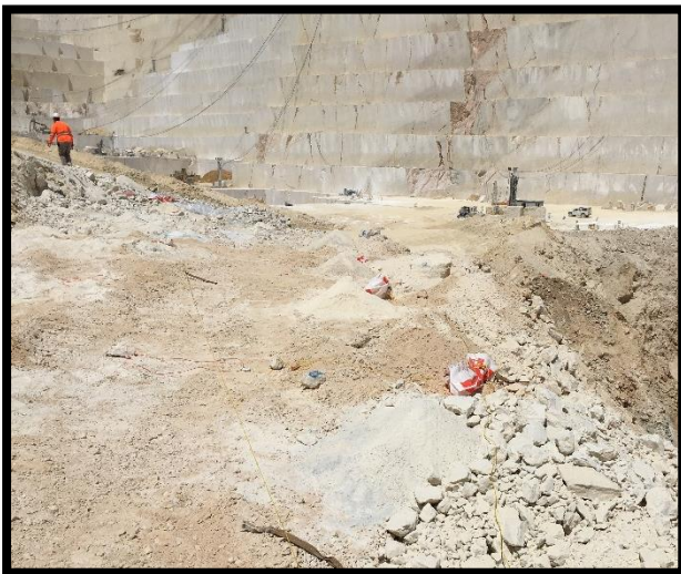
Ilustración 14. Carga de la voladura convencional en banco.
