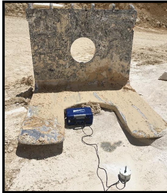
Ilustración 7. Disposición del equipo BLASTMATE III protegido improvisadamente por una placa porta implementos.
