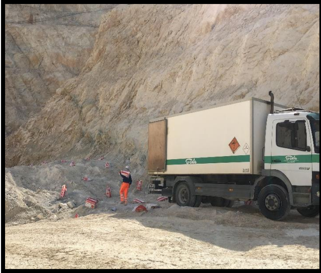
Ilustración 15. Carga de la voladura convencional en banco.
