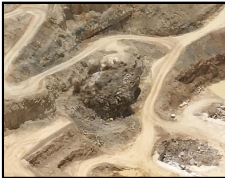
Ilustración 1. Secuencia en la pega de una voladura convencional en banco situada en la cantera donde se ha realizado el estudio.
