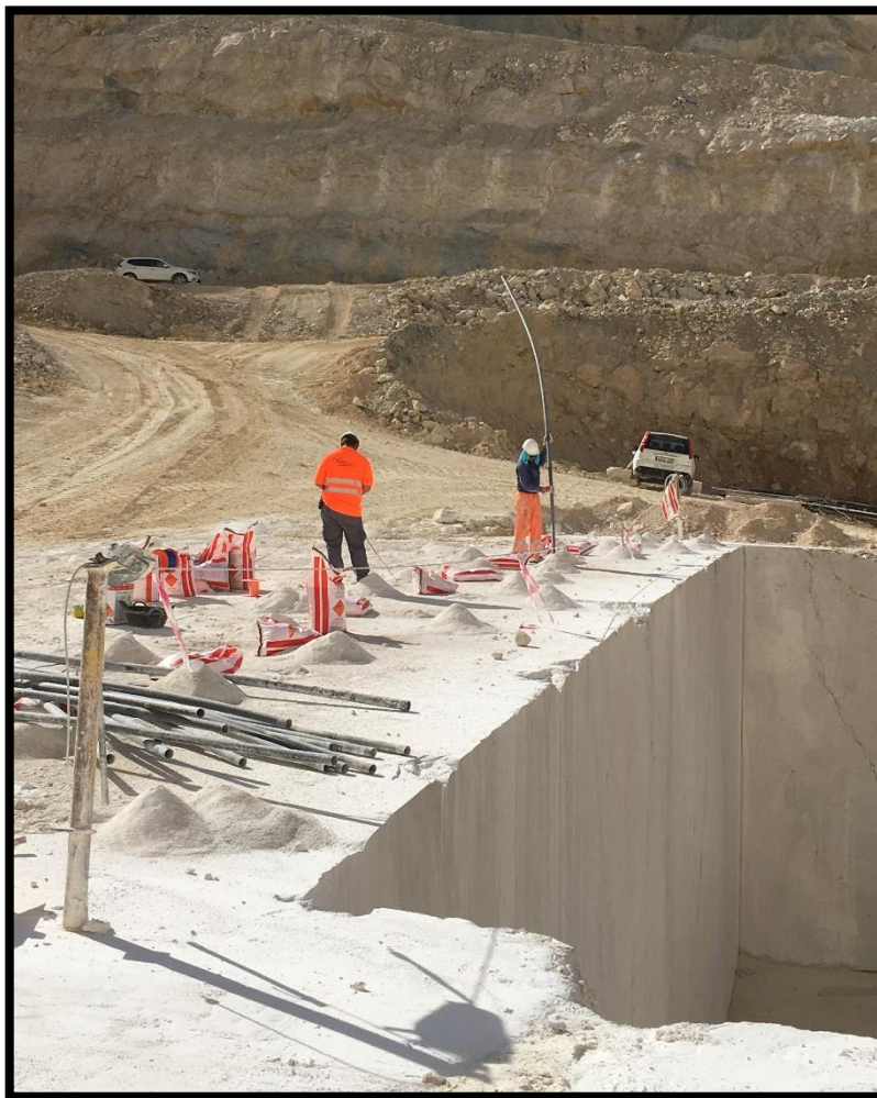
Ilustración 4. Imagen tomada de una de las voladuras estudiada en mármol con precorte mecanizado.
