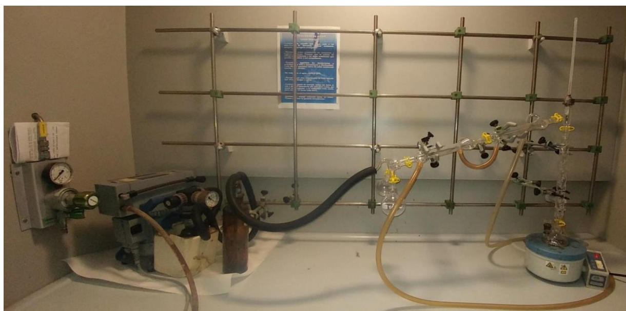
Figura 4.1. Equipo de destilación y bomba de vacío utilizados para la purificación del pirrol.
