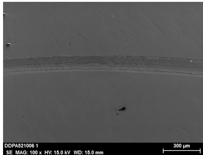
Figura 58. Micrografía de la huella a 100x (Agua + 1%(DPa + 0,1% Grafeno)).
