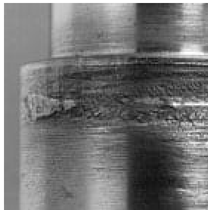
Figura 4. Pieza con desgaste adhesivo.
