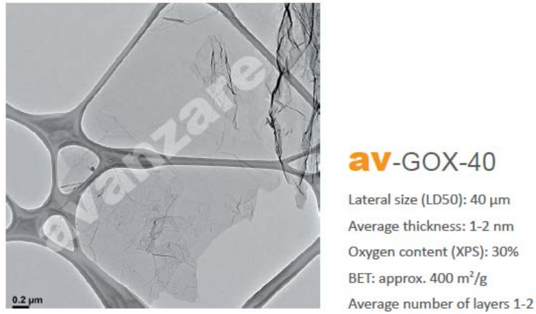
Figura 3.3. Estructura del av-GOX-40.
