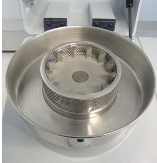
Figura 3.26. Rotor y tamiz utilizados para la molienda de la granza de los polímeros puros.
