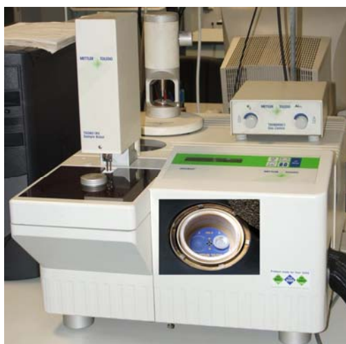
Figura 3.17. Calorímetro con detalle del horno.
