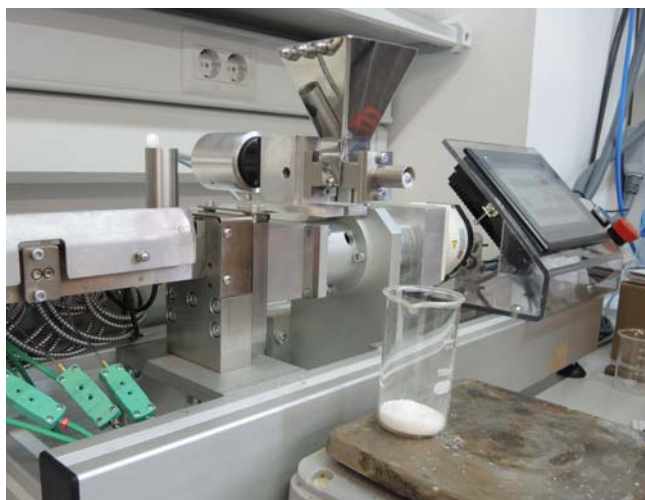
Figura 3.28. Proceso de calibración del caudal proporcionado por el feeder.
