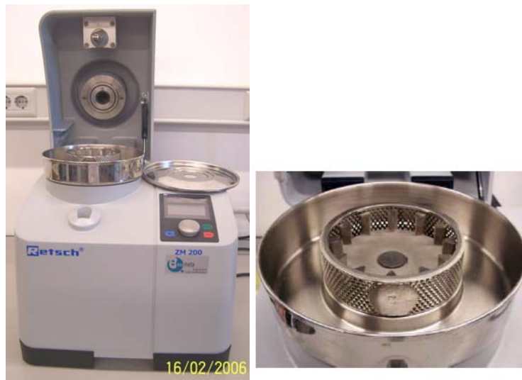
Figura 3.10. Molino RETSCH, modelo ZM 200 con detalle de las cuchillas.
